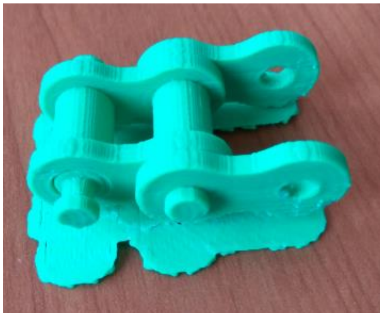
Slika 4.35. Proizvod A nakon otapanja potpornog materijala
