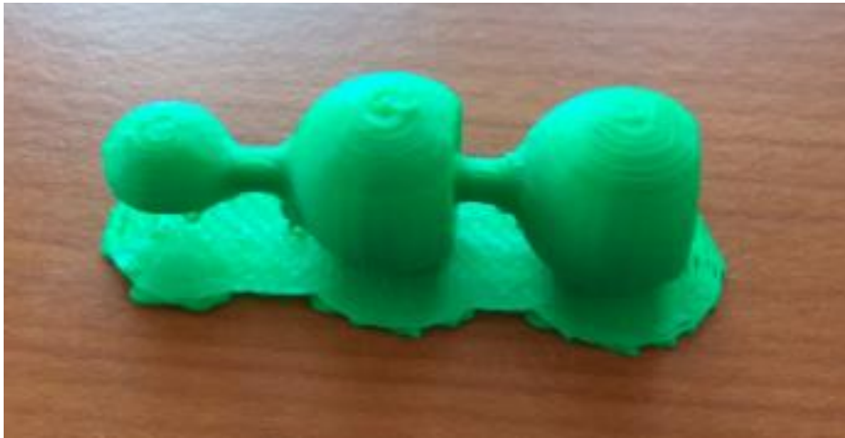
Slika 4.34. Proizvod B nakon otapanja potpornog materijala
