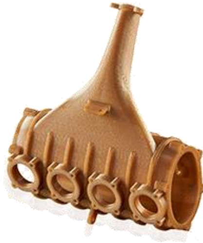
Slika 3.14. Proizvod načinjen od materijala ULTEM 1010 [48]
