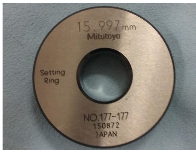
Slika 27. Kontrolni mjerni prsten \varnothing 15,997 mm
