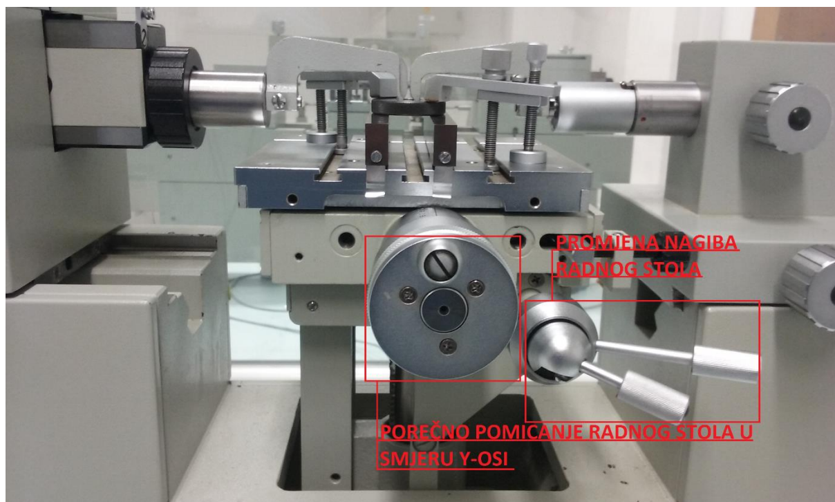
Slika 37. Traženje prekretno točke
