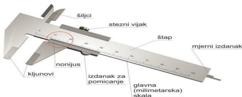
Slika 5. Klasično pomično mjerilo
