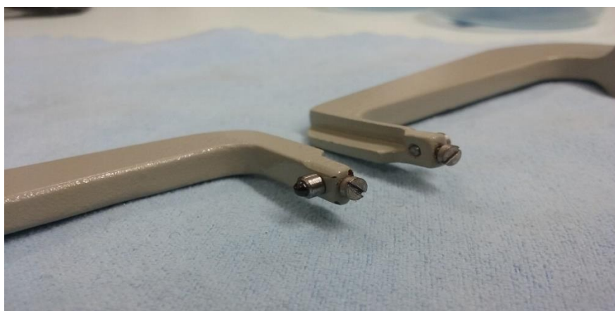
Slika 28. Male kontaktne čeljusti
