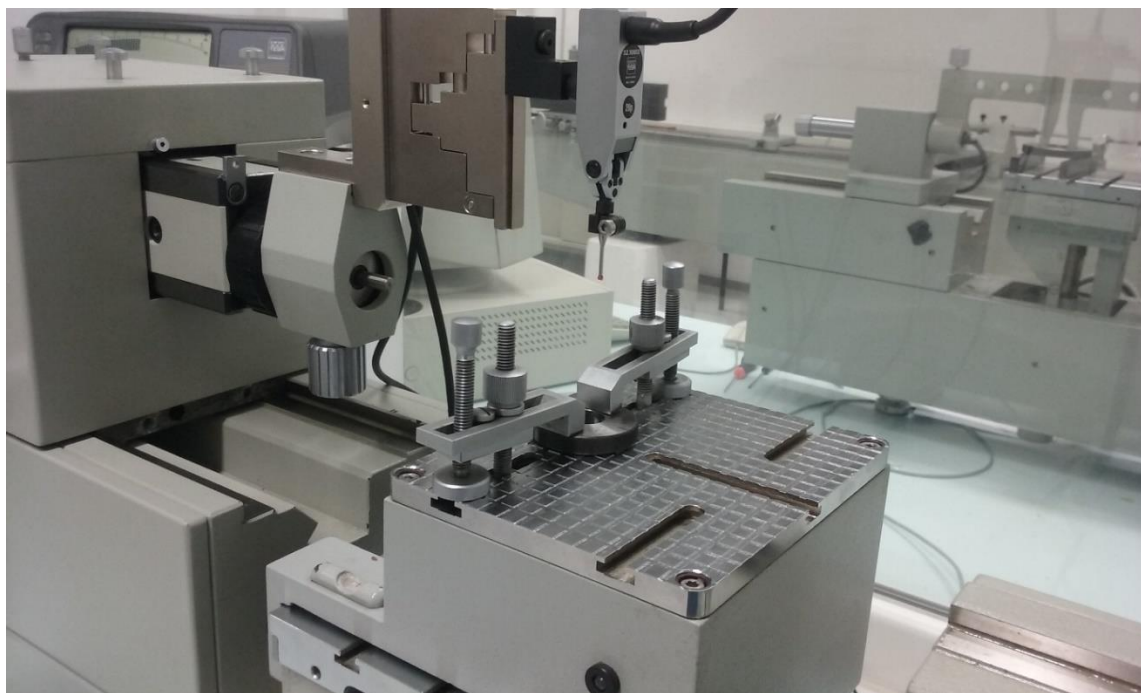
Slika 46. Pozicionirano ticalo iznad unutarnjeg promjera referentnog prstena
