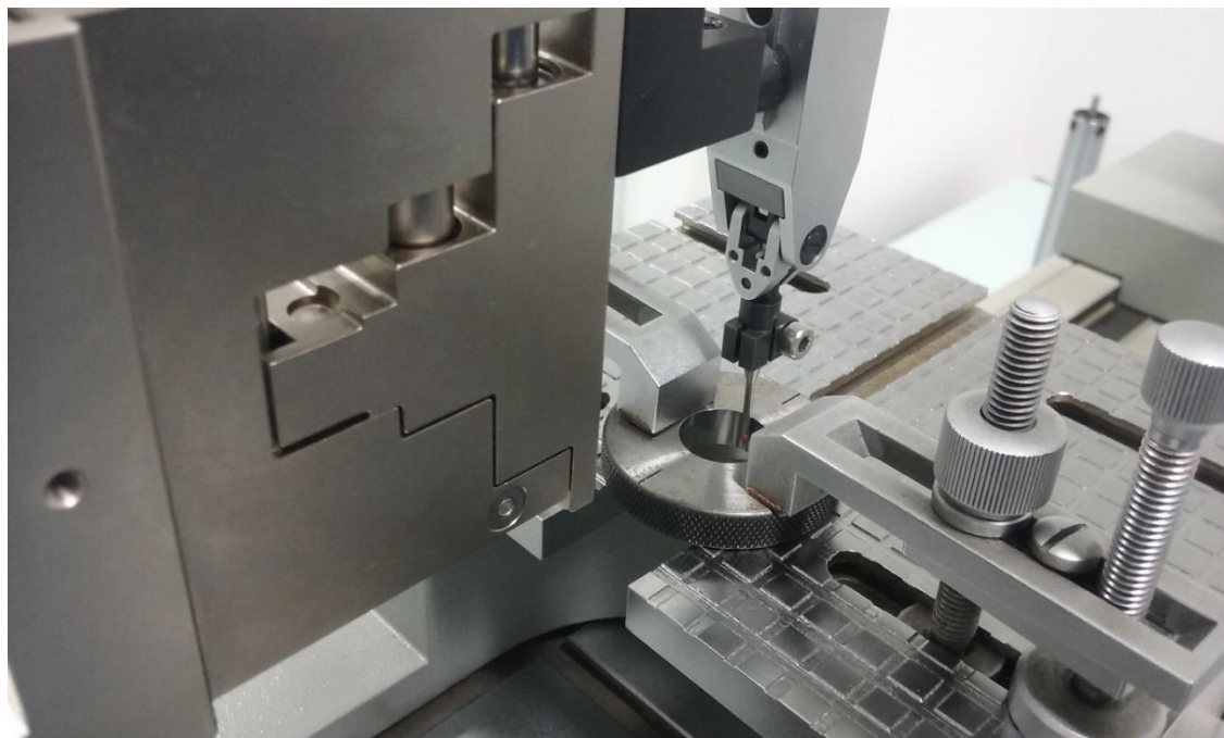
Slika 48. Ticalo u dodiru sa unutarnjom stranom referentnog prstena
