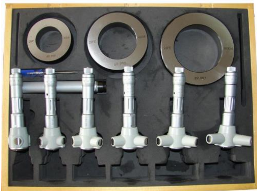
Slika 9. Set trokrakih mikrometara sa pripadajućim komponentama
