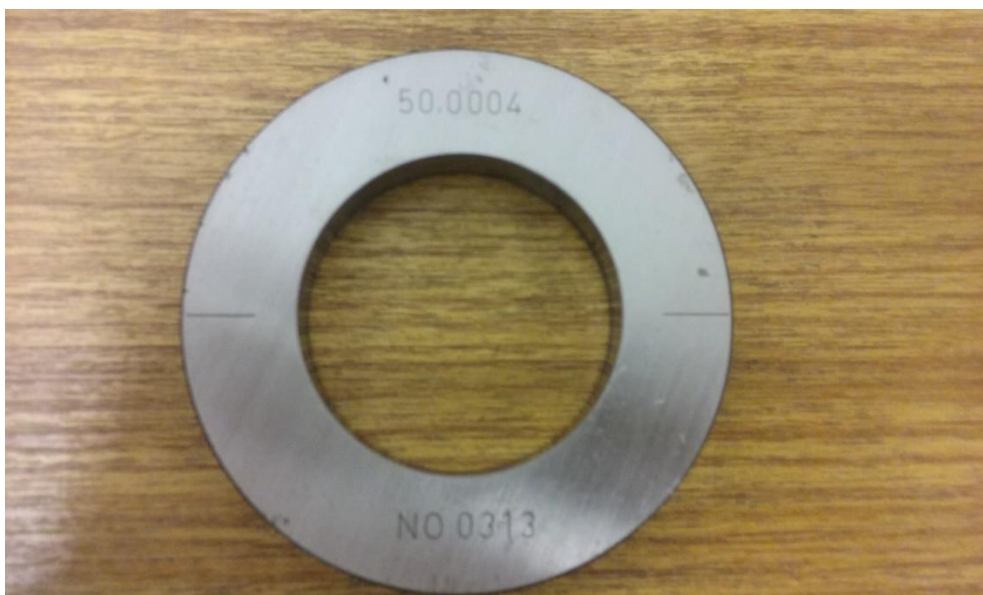
Slika 17. Referentni prsteni Ø50,0004 mm
