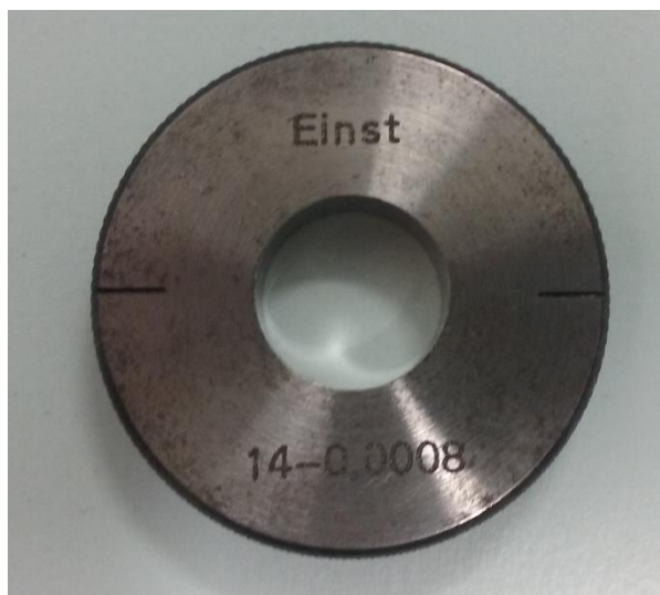
Slika 26. Referentni mjerni prsten \varnothing 13,9991 mm
