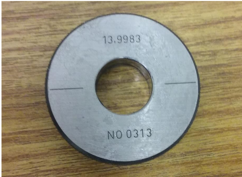
Slika 16. Referentni prsteni Ø13,9983 mm
