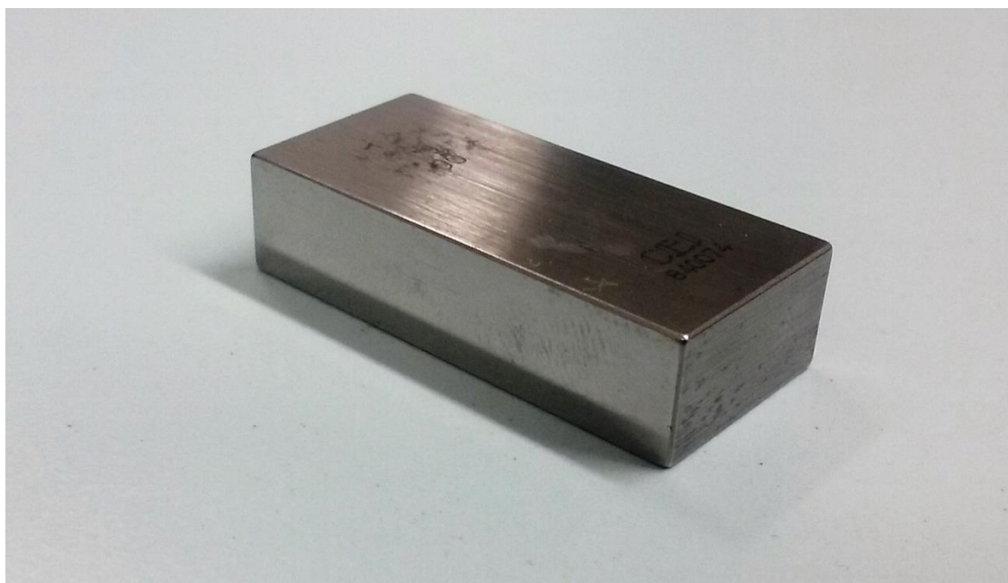
Slika 50. Planparalelna granična mjerka nazivne duljine 16 mm
