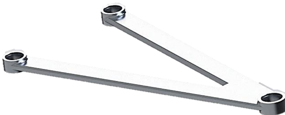
Slika 43. Koncept 1 – aluminijska vilica
