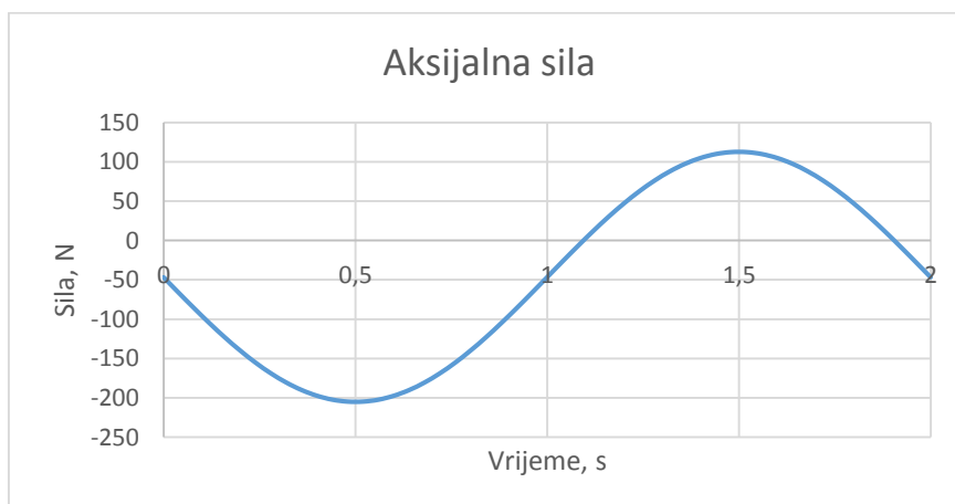
Slika 73. Aksijalna sila na zadnjem uniball -u gornje vilice
