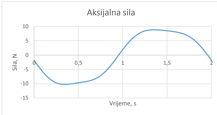
Slika 90. Aksijalna sila na uniball-u pushrod-a
