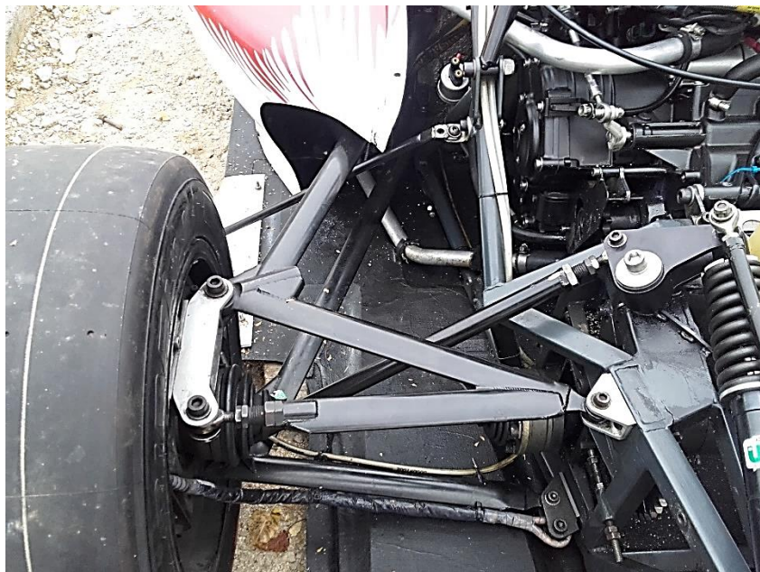
Slika 44. Koncept 2 – korištenje ovalnih cijevi u izradi ovjesa
