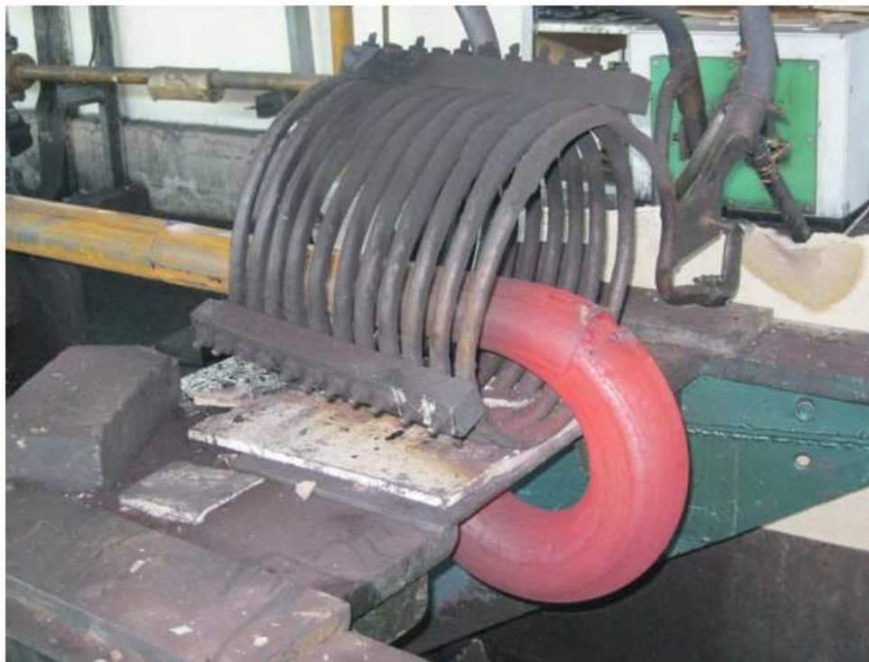
Slika 4. Cijevni luk dobiven hamburškim postupkom
