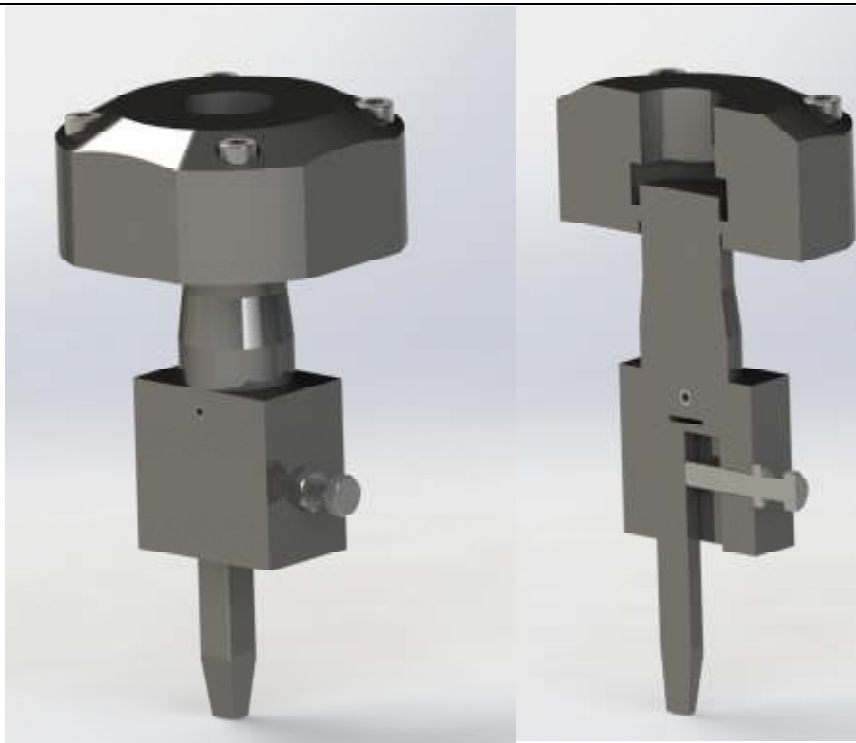
Slika 40. Sklop za prihvat žiga
