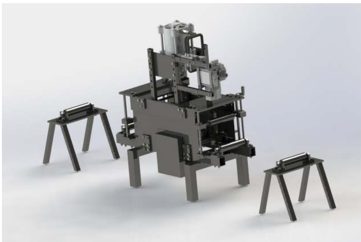
Slika 42. Stroj za utiskivanje žiga - pogled 2
