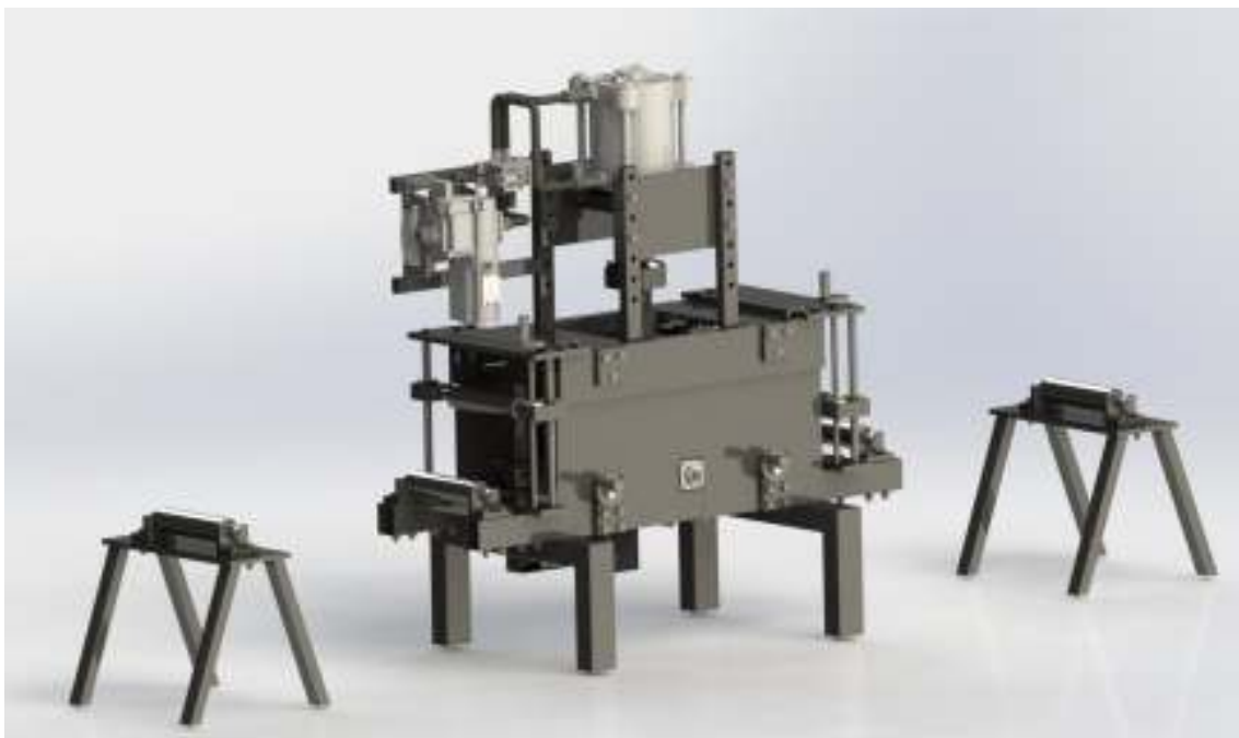
Slika 41. Stroj za utiskivanje žiga - pogled 1
