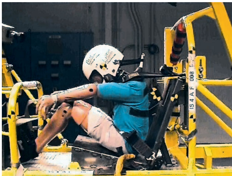
Slika 3. Testiranje HANS uređaja [2]
