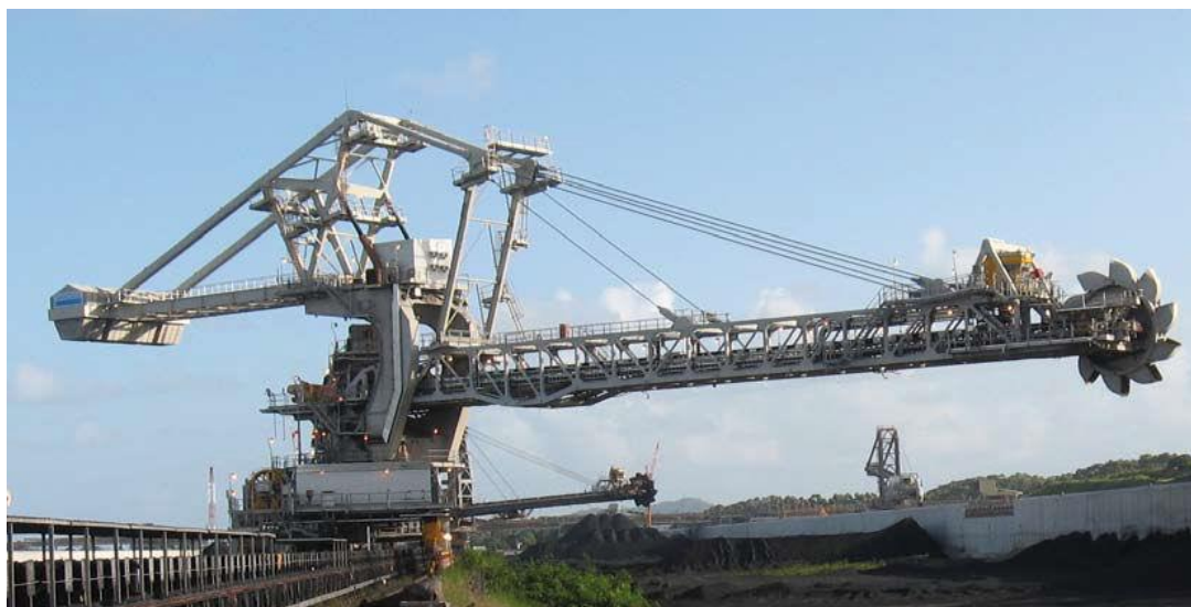
Slika 2. Uređaj za odlaganje/izuzimanje materijala Sandvik 6300 t/h
