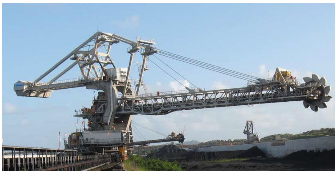
Slika 2. Uređaj za odlaganje/izuzimanje materijala Sandvik 6300 t/h
