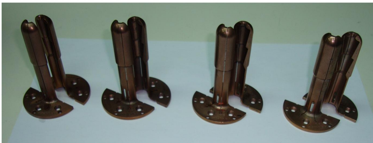
Slika 58. Izrađeni set prstiju gripera za Forerunner
