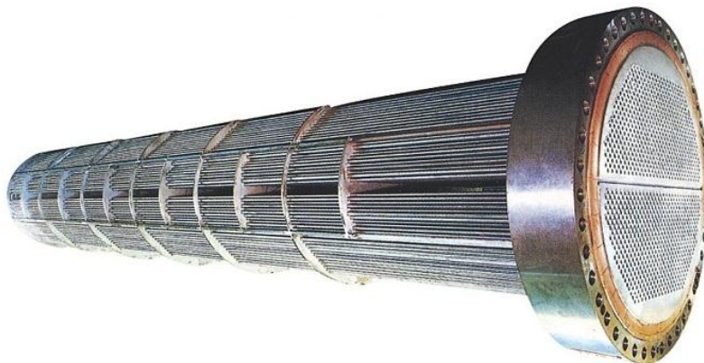
Slika 7. Cijevi parogeneratora spojene s cijevnom stijenom [9]
