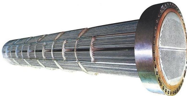
Slika 7. Cijevi parogeneratora spojene s cijevnom stijenom [9]
