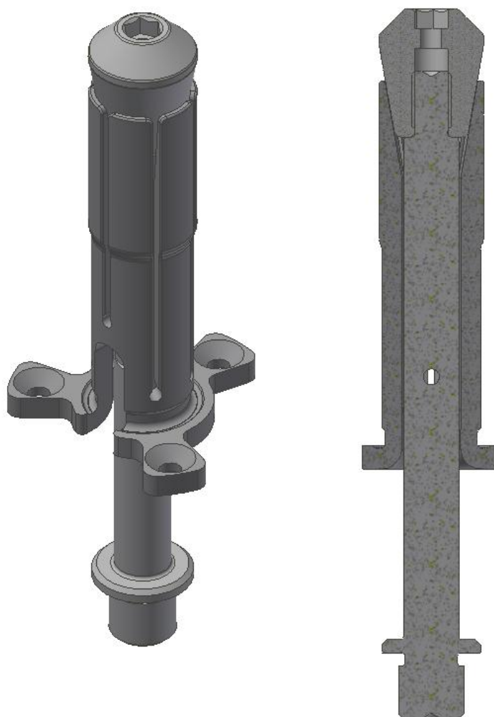
Slika 37. Geometrija prsta i trna gripera (prva verzija nove izvedbe)
