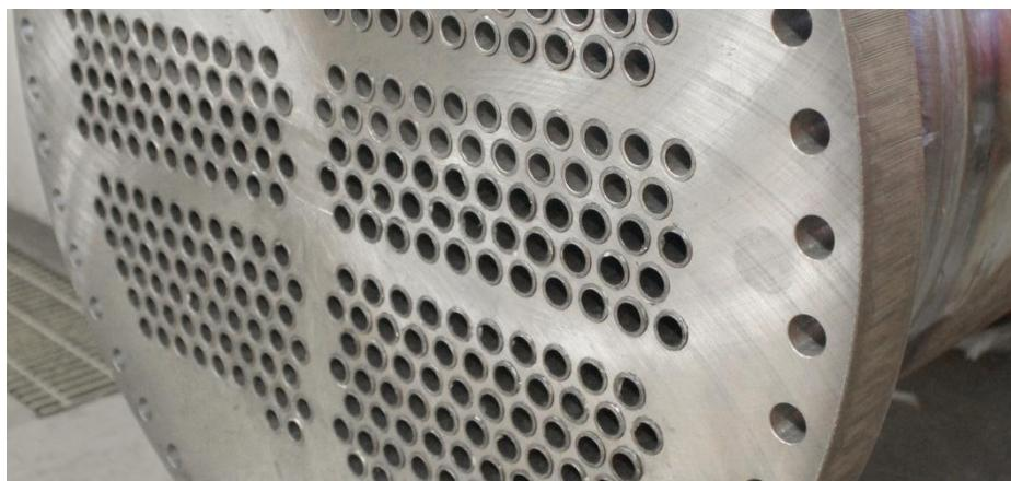
Slika 8. Spoj cijevi s cijevnom stijenom [10]
