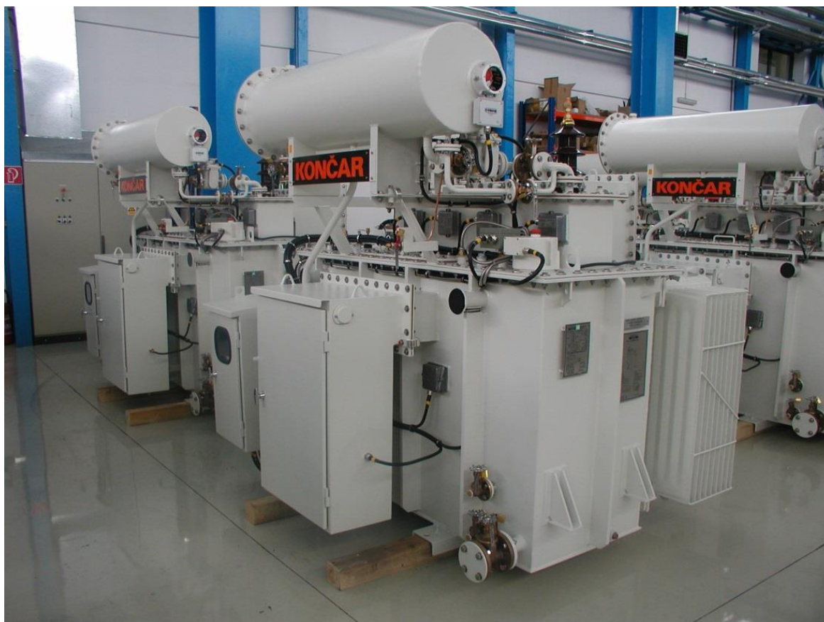
Slika 2.1 Distributivni transformator s kabelskom kutijom[3]
