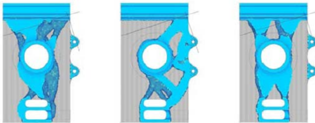
Slika 5.5. Rješenje za worst case scenario na nosaču kotača momčadi iz Indiane [9]
