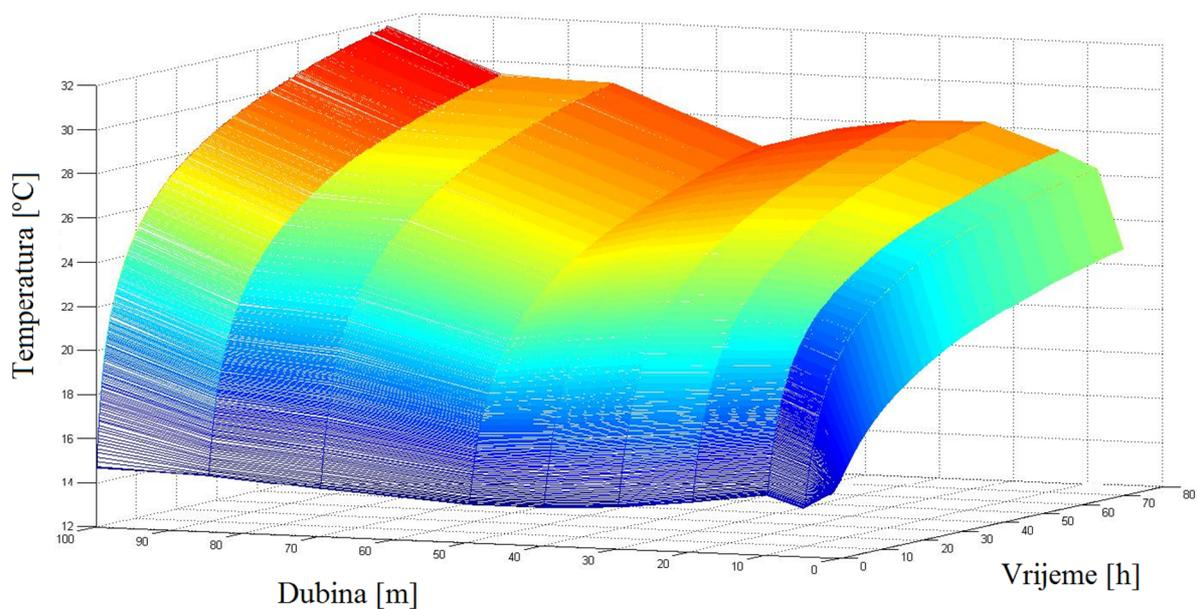
**Dijagram 4. 3D prikaz ovisnosti temperaturnog profila po dubini bušotine o vremenu tijekom drugog TRT-a [2]**
