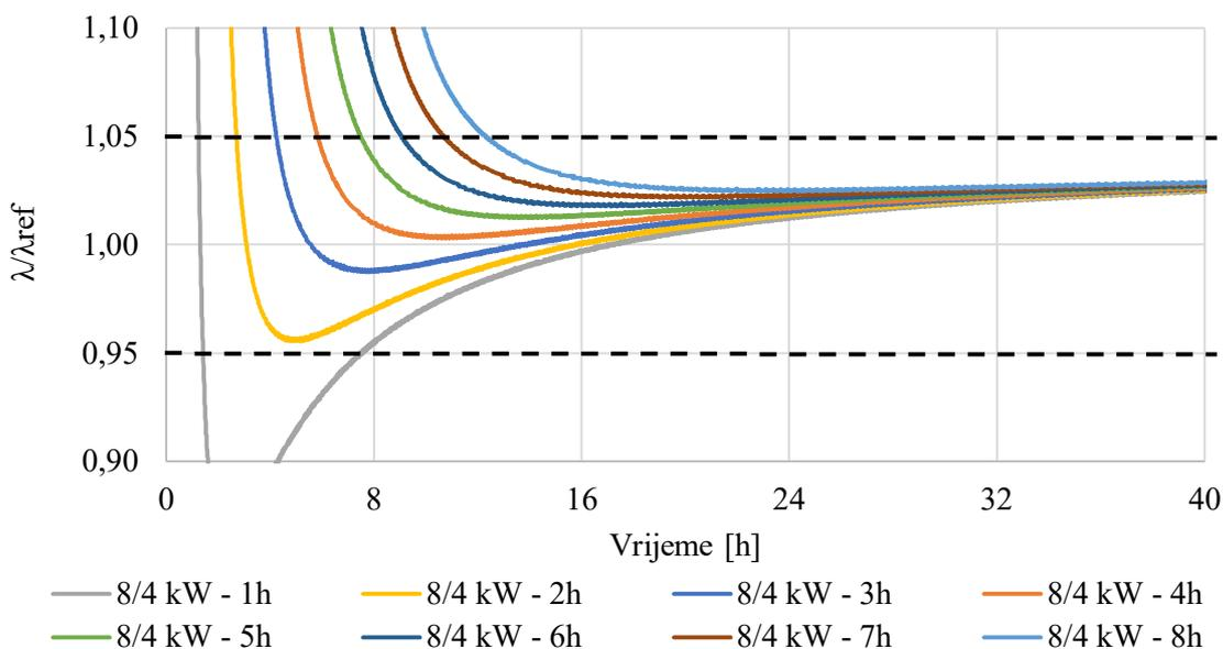
**Dijagram 8. Uvećani prikaz odstupanja efektivne toplinske provodnosti tla od referentne vrijednosti ovisno o vremenu razmatranja rezultata dobivenih simulacijom (8 kW na 4 kW) [2]**
