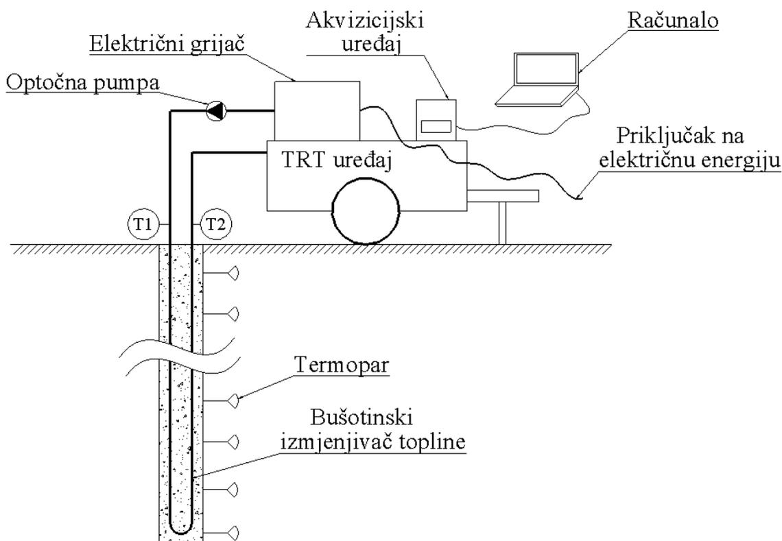
Slika 14. Shematski prikaz mjerne linije TRT uređaja [2]
