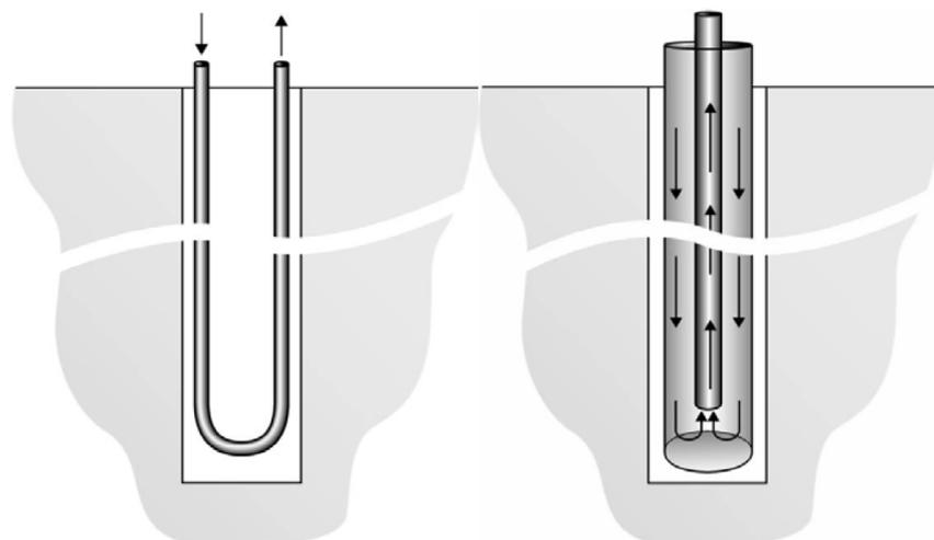
Slika 12. Jednostruka U-cijev i koaksijalni bušotinski izmjenjivač topline [7]
