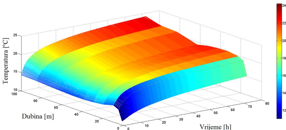
**Dijagram 2. 3D prikaz ovisnosti temperaturnog profila po dubini bušotine o vremenu tijekom prvog TRT-a [2]**
