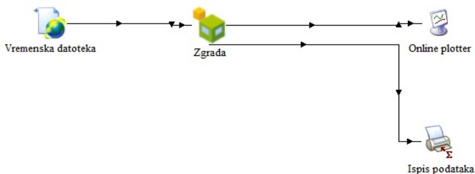
Slika 21. Shema simulacije u TRNSYS-u za određivanje godišnje potrebne energije za grijanje prostora
