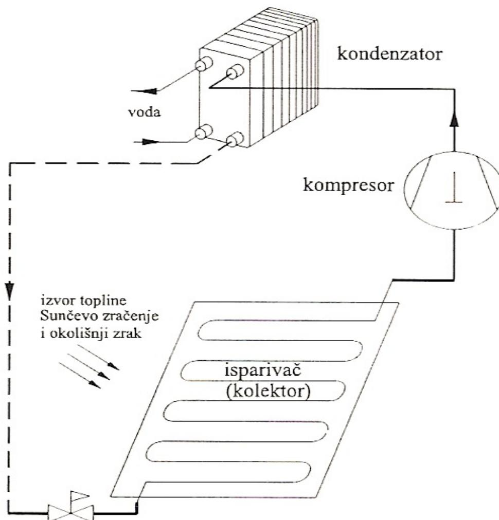
Slika 9. Shema sustava solarne dizalice topline [4]
