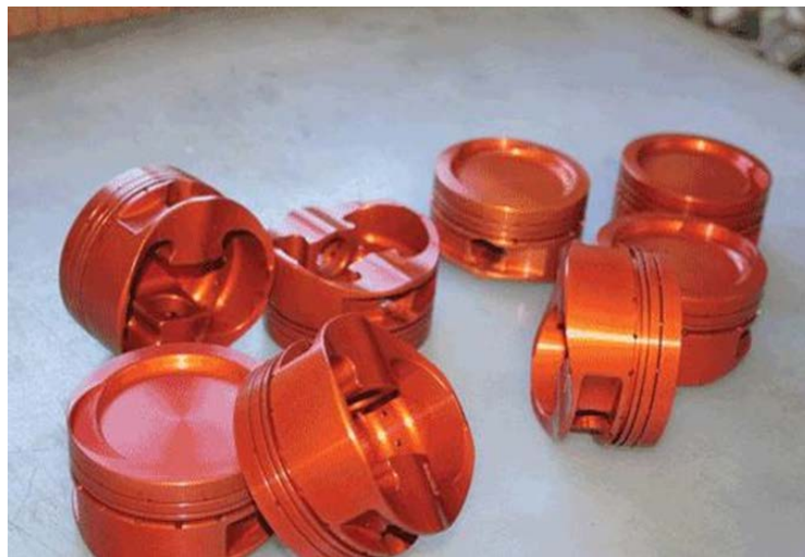
Slika 20. Aluminijski klipovi obrađeni elektrokemijskom oksidacijom [32]
