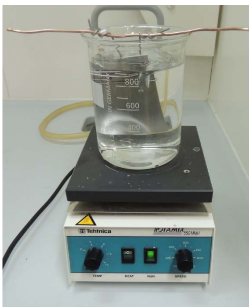
Slika 30. Ispiranje uzoraka na magnetskoj miješalici
