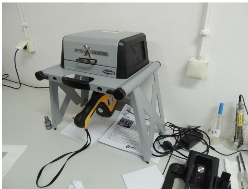
Slika 21. Određivanje kemijskog sastava pomoću XRF uređaja
