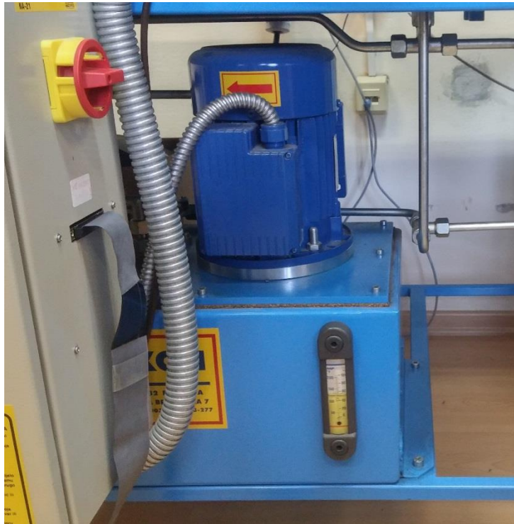
Slika 3. Spremnik tekućine i hidraulička crpka
