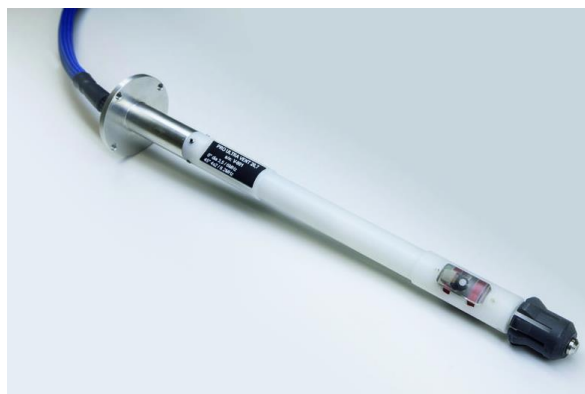
Slika 6. Sonda za ispitivanje ventila reaktora ultrazvučnom metodom [4]
