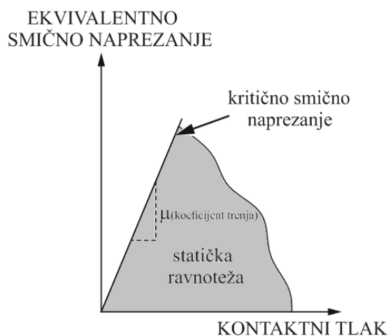
Slika 24. Dijagram statičke ravnoteže do kritičnog smičnog naprezanja
