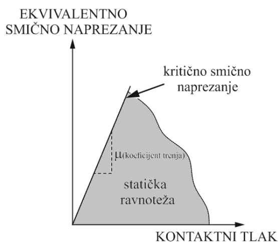
Slika 24. Dijagram statičke ravnoteže do kritičnog smičnog naprezanja
