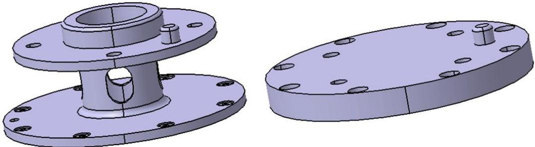
**Slika 51.** CAD model adapterske ploče „UR5” - senzor sile veće i manje
