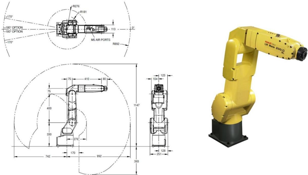
Slika 18. „Fanuc LR Mate 200iC/5L”: dimenziije radnog prostora i gabarita (lijevo) te fotografija robota (desno)
