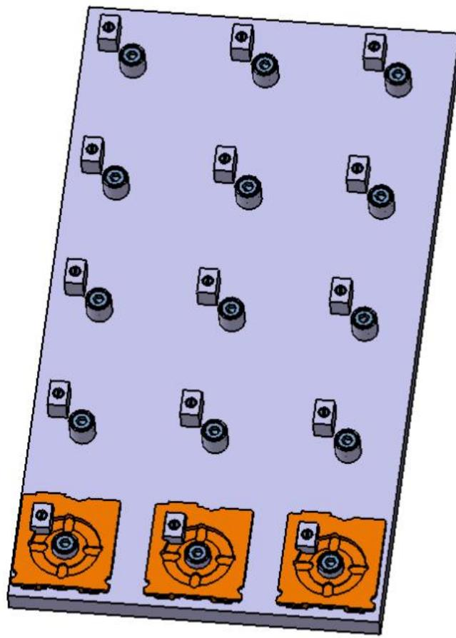
**Slika 81. Paleta s poklopцима i novom orijentacijskom značajkom**
