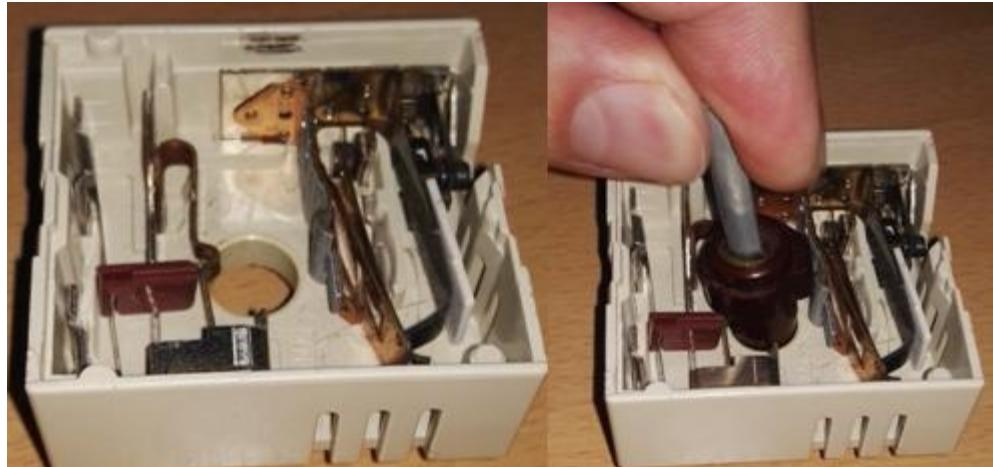
Slika 30. Umetanje vratila u kućište termoregulatora
