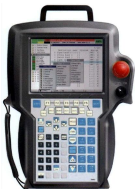
Slika 24. Privjesak za učenje industrijskog robota „Fanuc”
