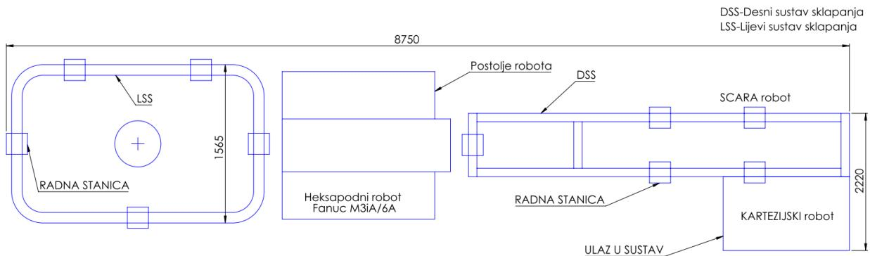
Slika 2. Shema prostornog rasporeda opreme u novom laboratoriju
