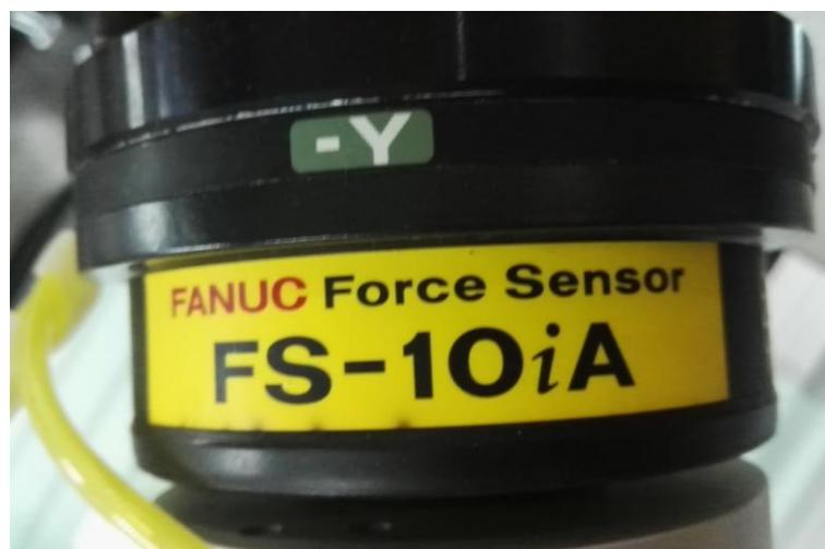
Slika 31. Senzor sile „Fanuc FS-10iA”
