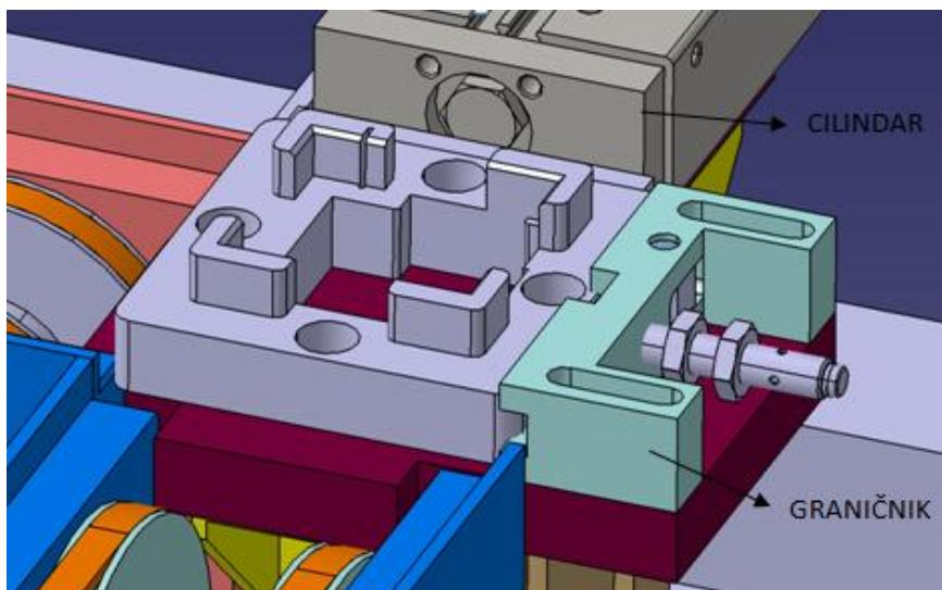
**Slika 73. Cilindar i graničnik koji osiguravanju nastavak transporta nosača proizvoda**
