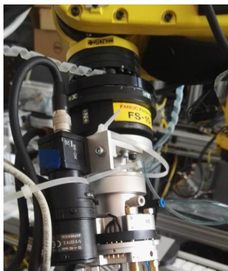
Slika 33. Izmjenjivač alata „SMC MA310” montiran na robot u laboratoriju
