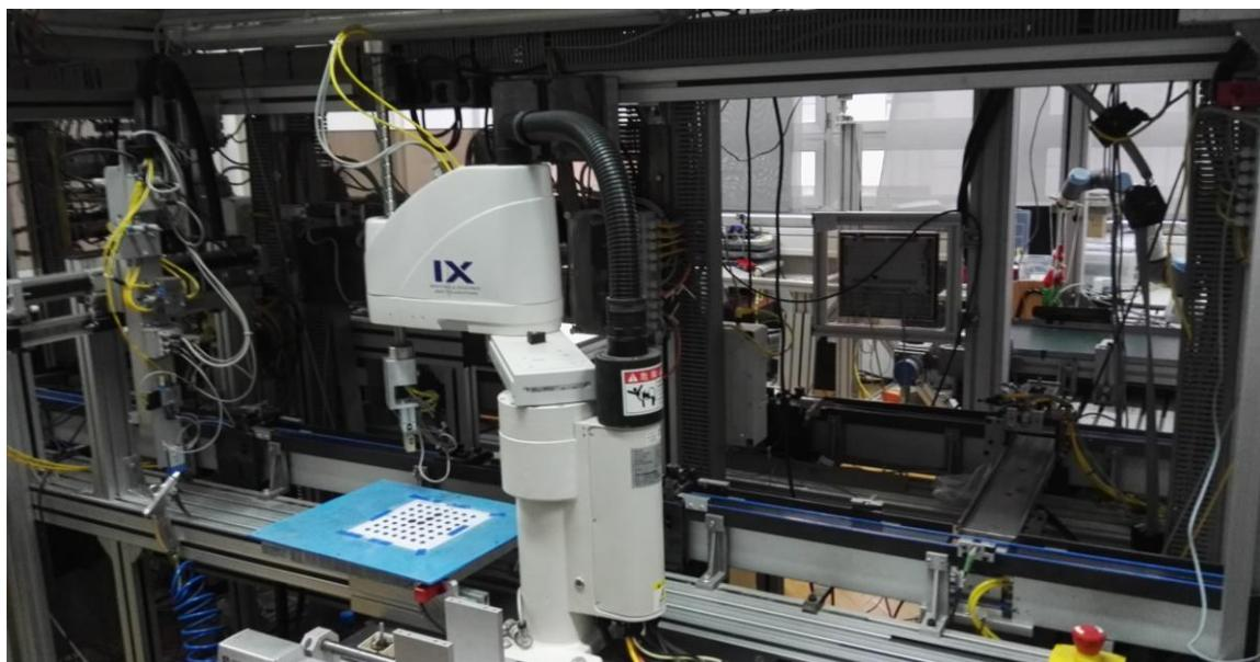
Slika 102. SCARA robot i „Festo” manipulator
