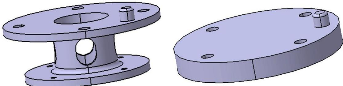
**Slika 52.** CAD model adapterske ploče senzor sile - izmjenjivač „SWK 011” veće i manje
