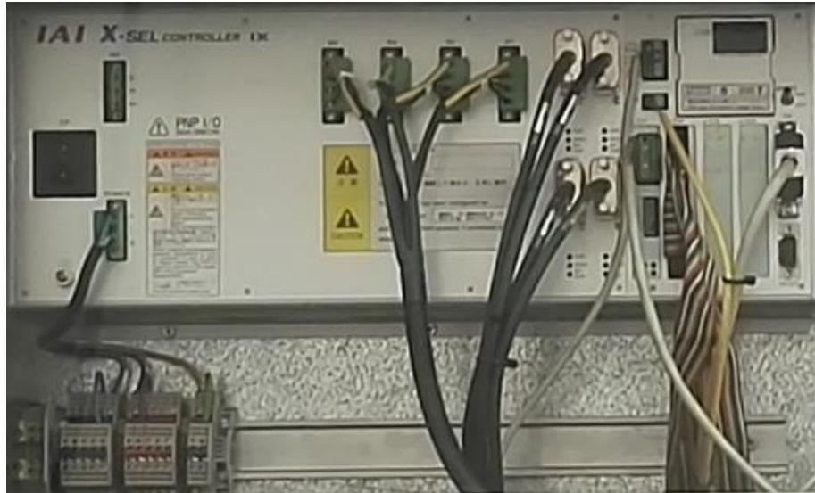
Slika 25. „IAI X-SEL controller IX” u sklopu laboratorijskog sistema za SCARA industrijski robot
