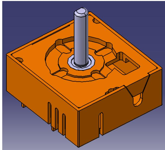
Slika 9. Sklop termoregulatora
