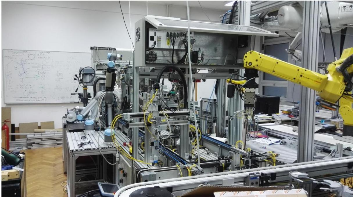
**Slika 109.** Konačan izgled sustava za robotsko sklapanje i rasklapanje termoregulatora
