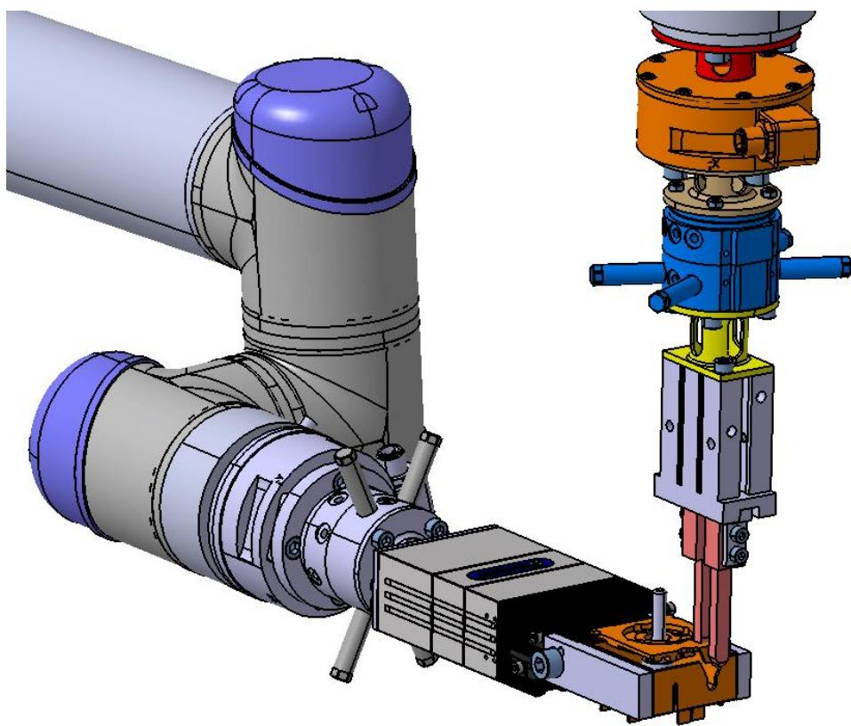
Slika 64. CAD prikaz skidanja poklopca sa sklopa termoregulatora
