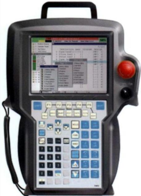
Slika 24. Privjesak za učenje industrijskog robota „Fanuc”
