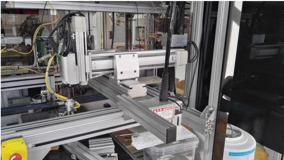
Slika 22. „IA Intelligent Actuator” Kartezijjski robot
