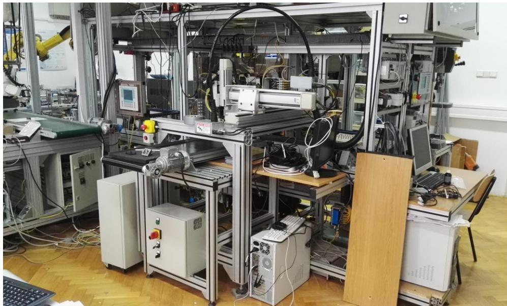
Slika 99. Transportni sustav bez zaštitne ograde sa strane Kartejskog robota
