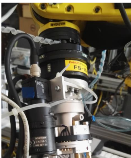
Slika 33. Izmjenjivač alata „SMC MA310” montiran na robot u laboratoriju
