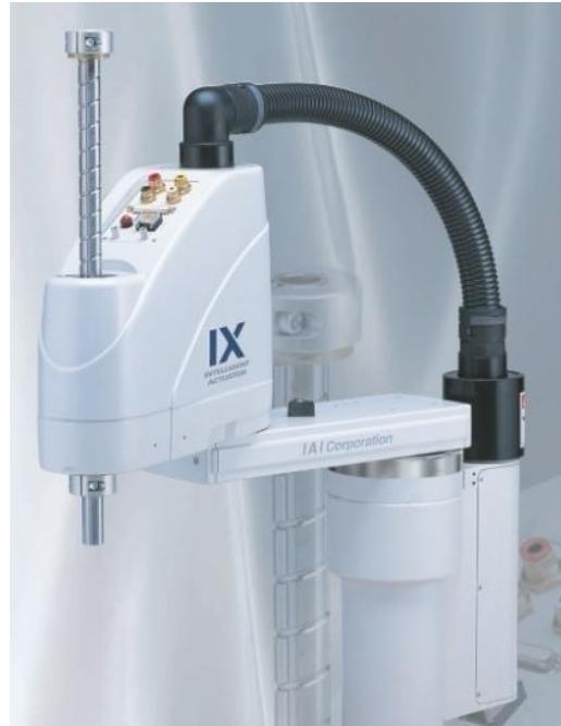
Slika 17. „IX Intelligent Actuator” SCARA robot
