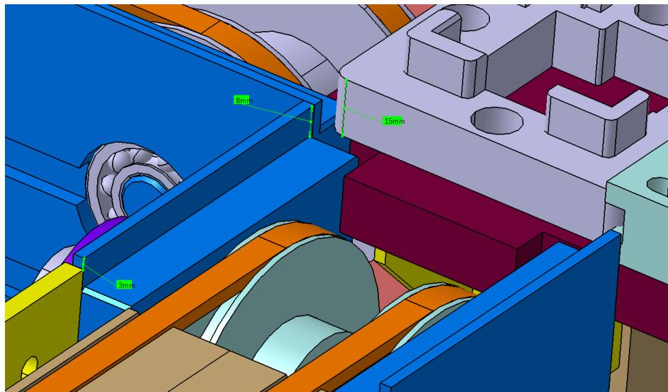
**Slika 72. Stari nosač proizvoda na transportnoj traci**
