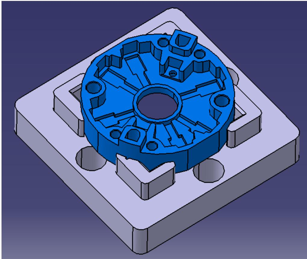
Slika 68. Kućište grebenaste sklopke na univerzalnom nosaču proizvoda
