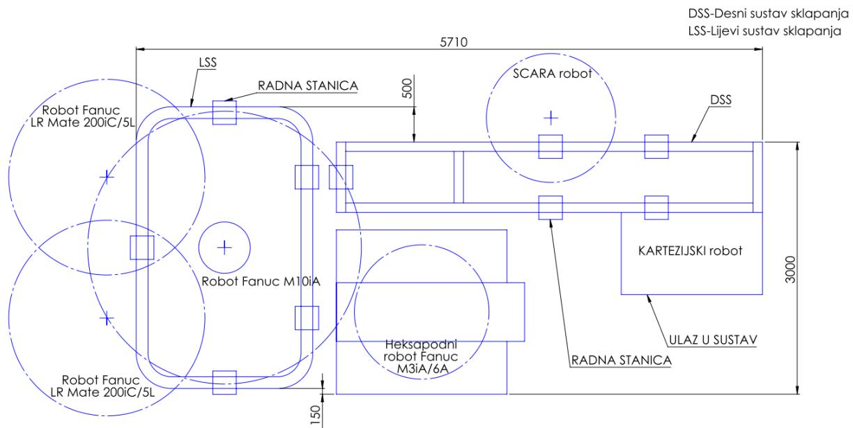
**Slika 1.** Shema prostornog rasporeda opreme u sadašnjem laboratoriju
