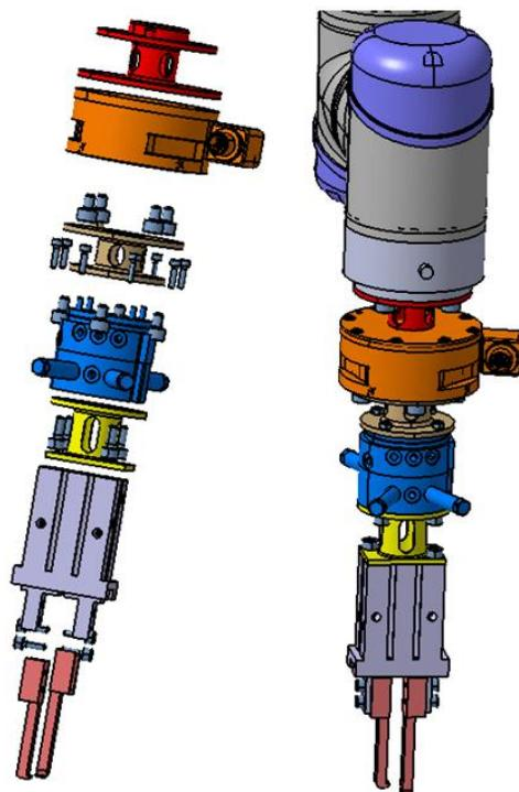
Slika 63. CAD model sklopa od robota do prstiju za vađenje poklopca (veći adapteri)
