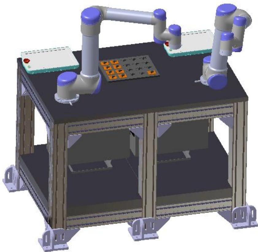
Slika 90. Sklop većeg stola sa „Universal Robots UR5” robotima i popratnom opremom
