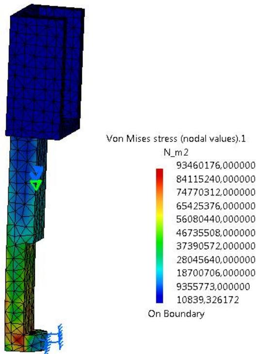
Slika 39. Prst za stavljanje poklopca proveden kroz metodu konačnih elemenata
