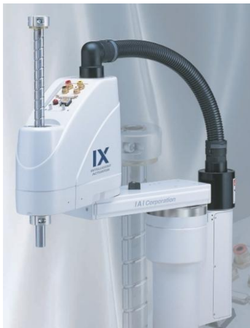
Slika 17. „IX Intelligent Actuator” SCARA robot
