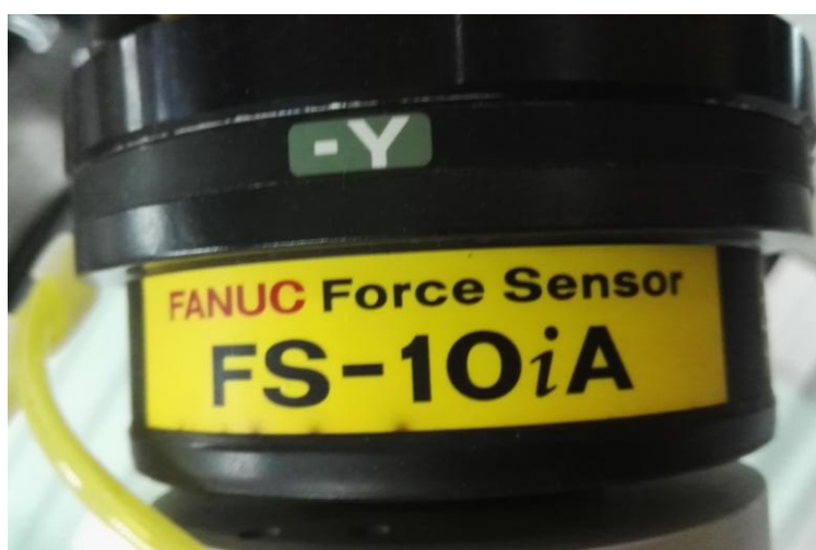
Slika 31. Senzor sile „FANUC FS-10iA”
