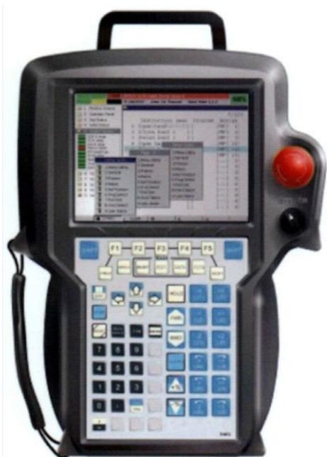
Slika 24. Privjesak za učenje industrijskog robota „Fanuc”
