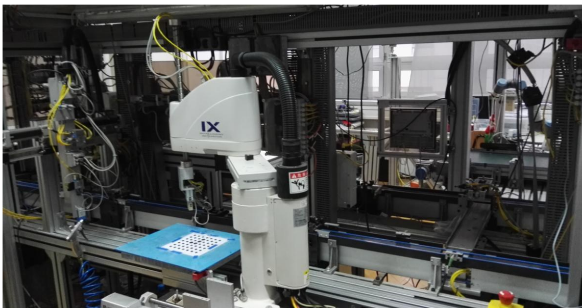
Slika 102. SCARA robot i „Festo” manipulator
