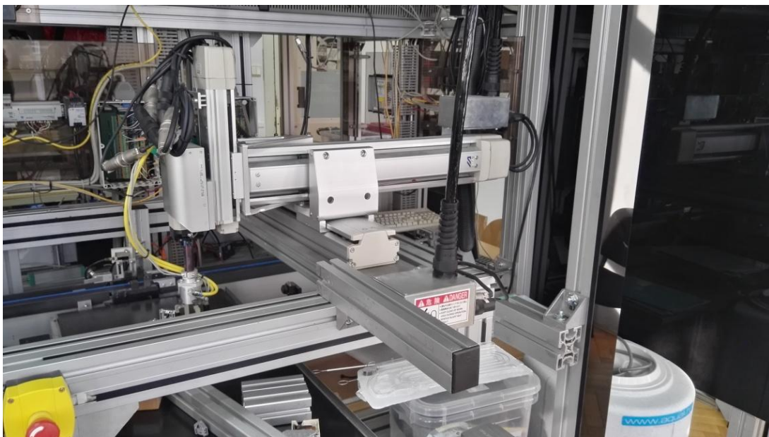
Slika 22. „IA Intelligent Actuator” Kartezijski robot
