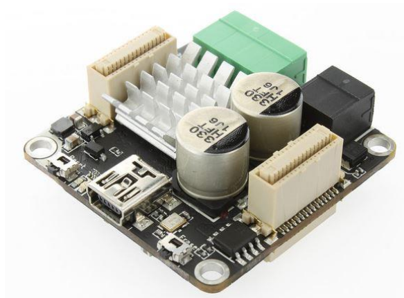
Slika 34. Tinkerforge Brick za upravljanje bipolarnim koračnim motorom
