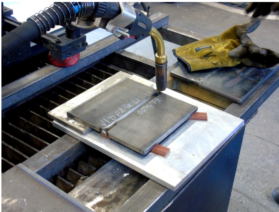
Slika 33. Pripremljene ploče za zavarivanje
