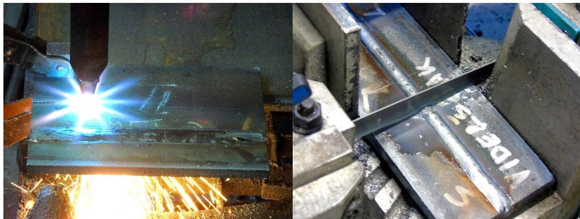
**Slika 38. Izrezivanje uzorka plinski i tračnom pilom**
