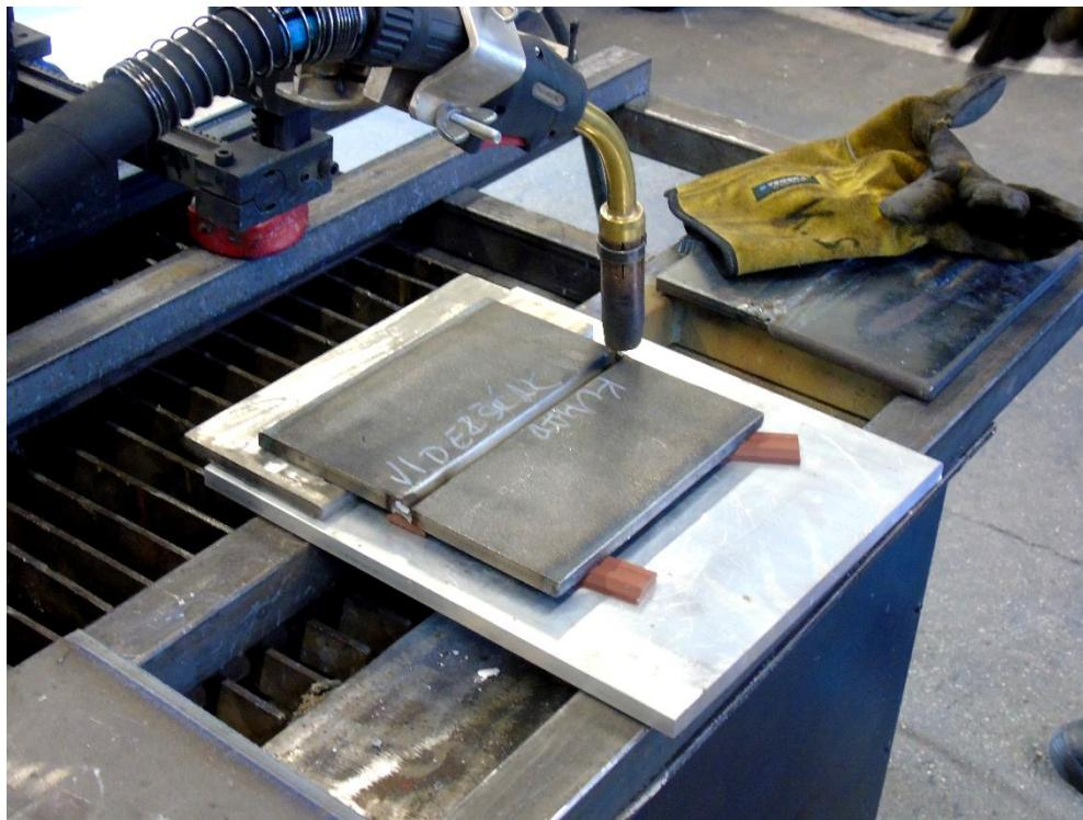
**Slika 33. Pripremljene ploče za zavarivanje**
