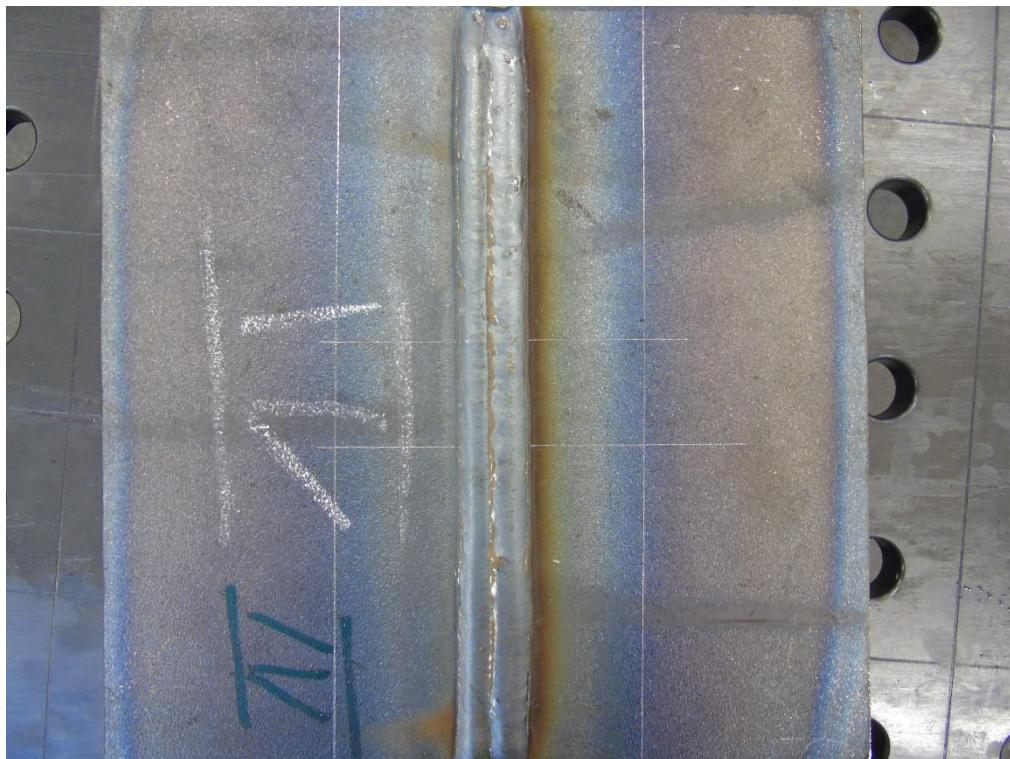
Slika 37. Označavanje ploče za izrezivanje uzorka
