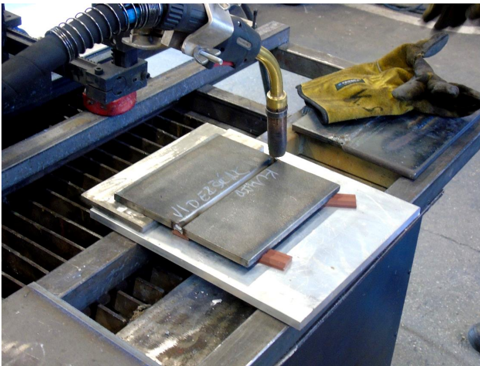
Slika 33. Pripremljene ploče za zavarivanje
