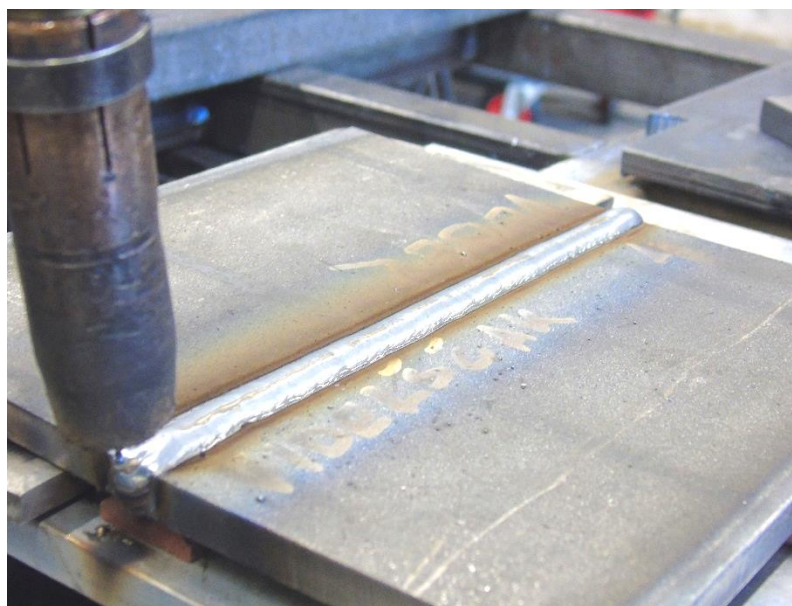
Slika 36. Izgled trećeg prolaza na uzorku 3
