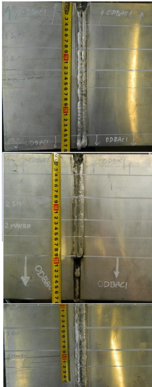
Slika 28. Priprema ispitnih uzoraka za rezanje
