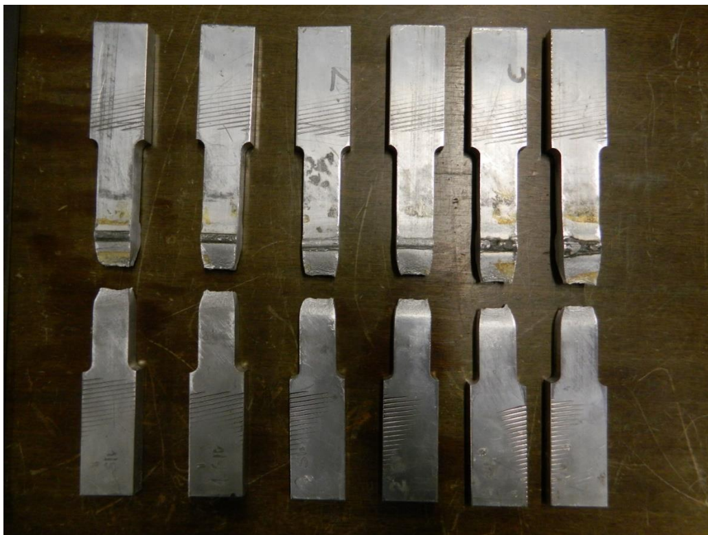
Slika 33. Uzorci nakon statičkog vlačnog ispitivanja
