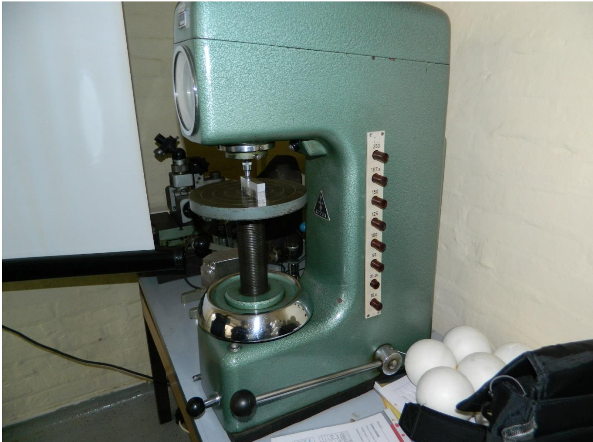
Slika 49. Uređaj WPM 300/50 za utiskivanje kuglice na uzorke prema Brinellovoj metodi (2,5/31,25)
