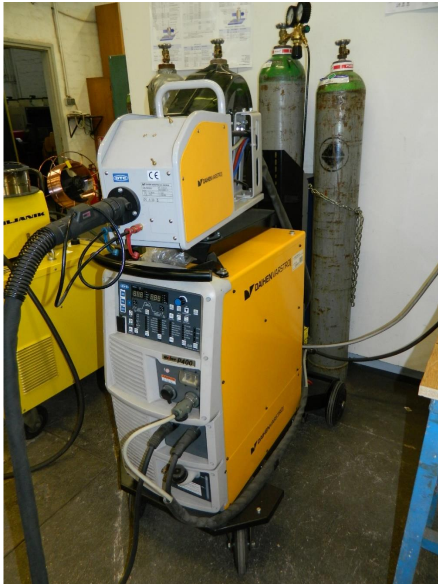
Slika 21. Izvor struje za zavarivanje DAIHEN VARSTROJ WB-P400
