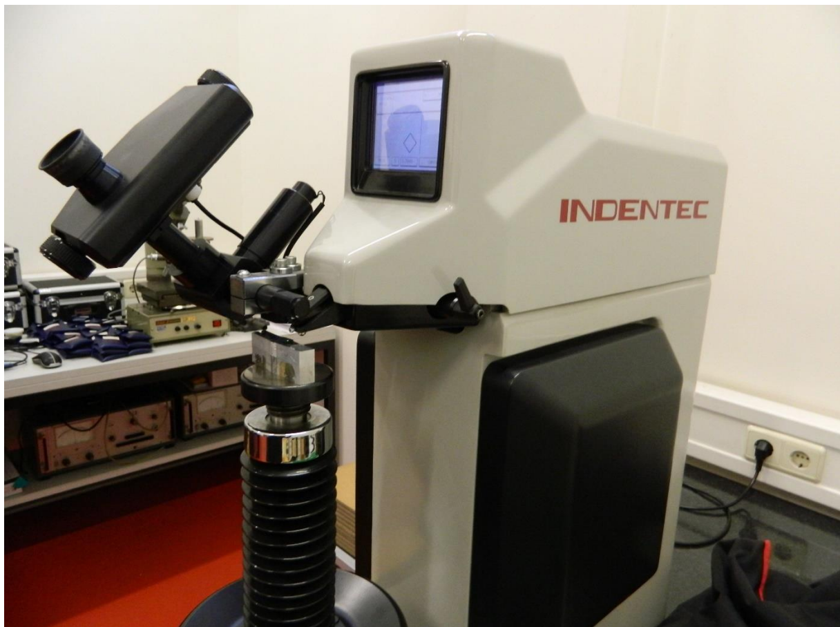
Slika 51. Mjerenje promjera d_1 i d_2 otiska pomoću mjernog mikroskopa
