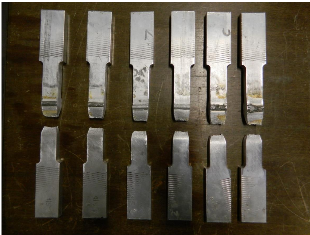
Slika 33. Uzorci nakon statičkog vlačnog ispitivanja
