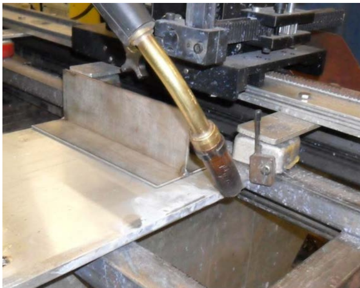
Slika 45. Postav eksperimenta za zavarivanje ispitnog T-spoja
