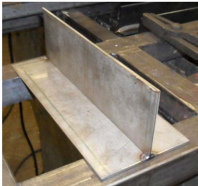
Slika 42. Priprema T-spoja za zavarivanje
