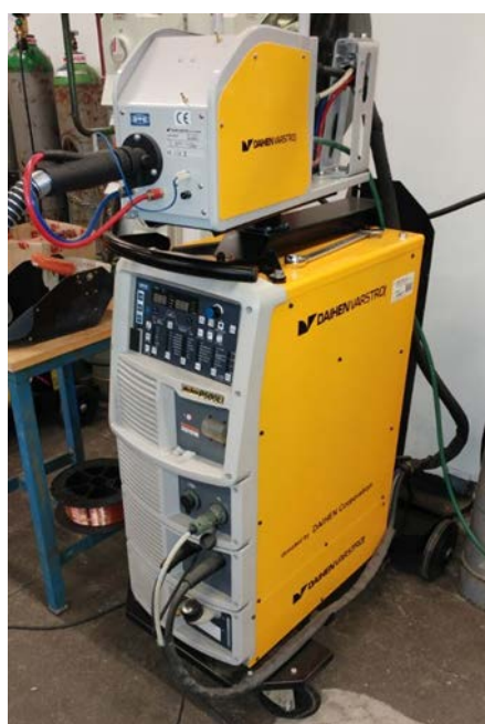
Slika 43. Uređaj za zavarivanje DAIHEN VARSTROJ Welbee P500L
