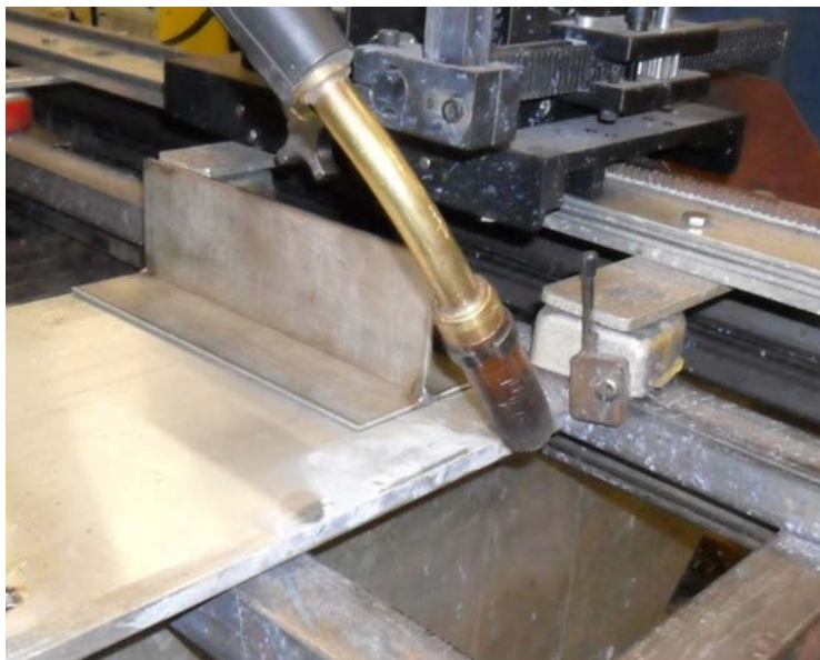
Slika 45. Postav eksperimenta za zavarivanje ispitnog T-spoja
