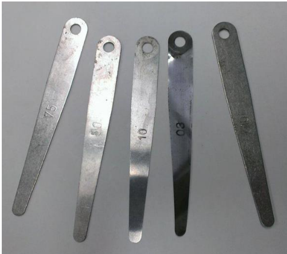
Slika 17. Korišteni etaloni debljine
