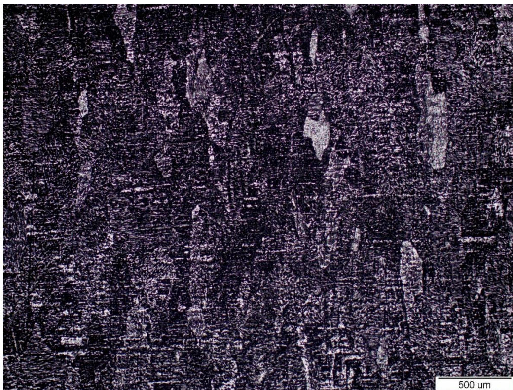
Slika 57: Mikrostruktura zone utjecaja topline
