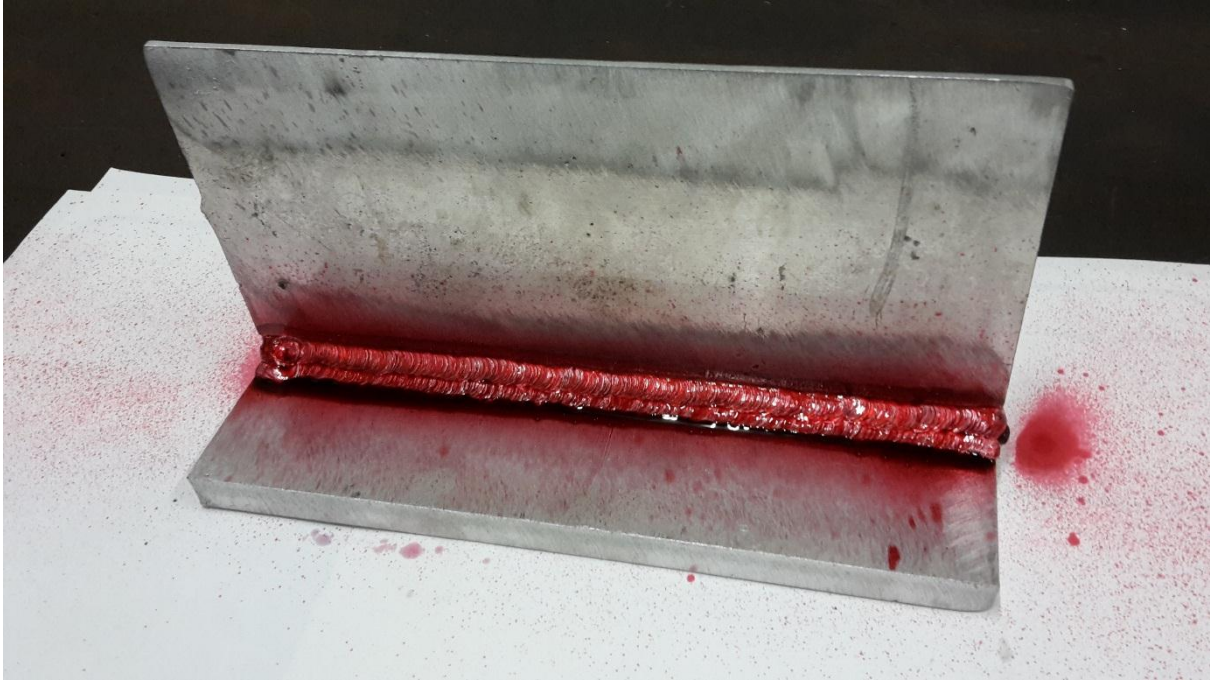
Slika 49: Sloj penetranta na ispitnom uzorku
