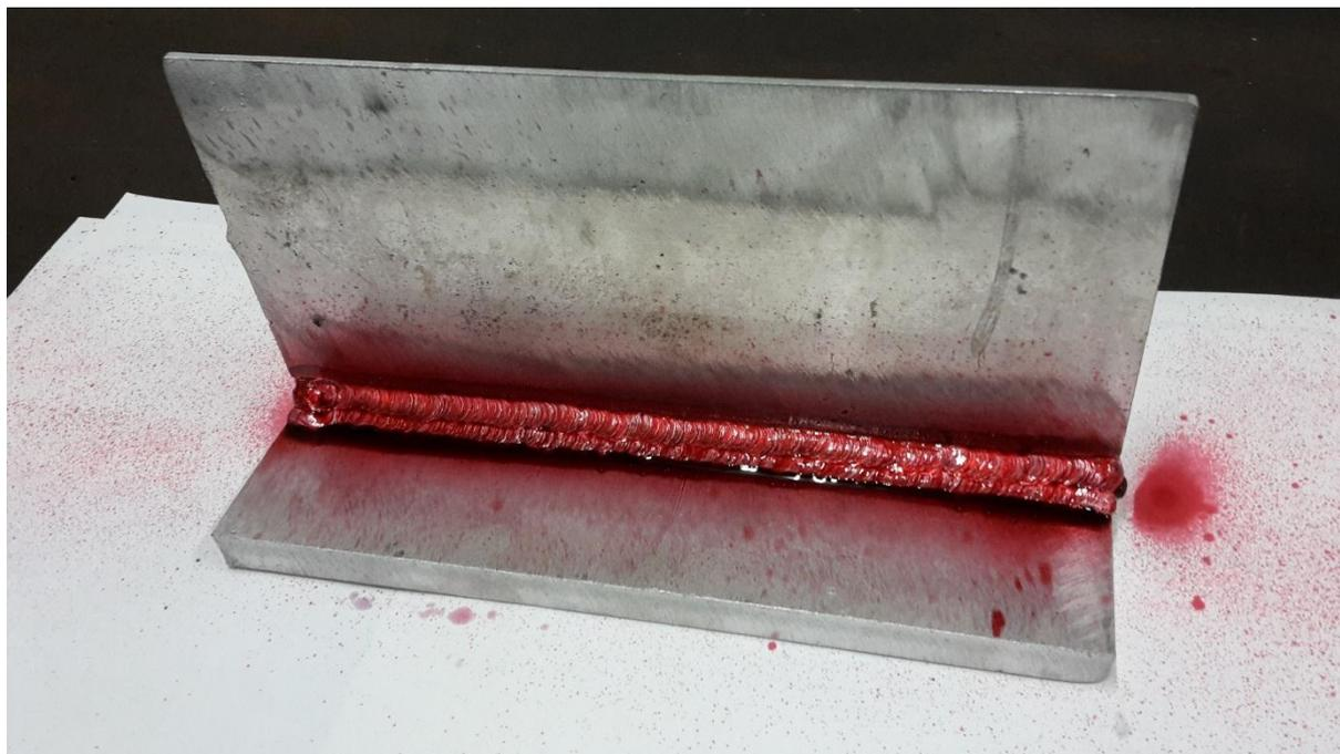
Slika 49: Sloj penetranta na ispitnom uzorku
