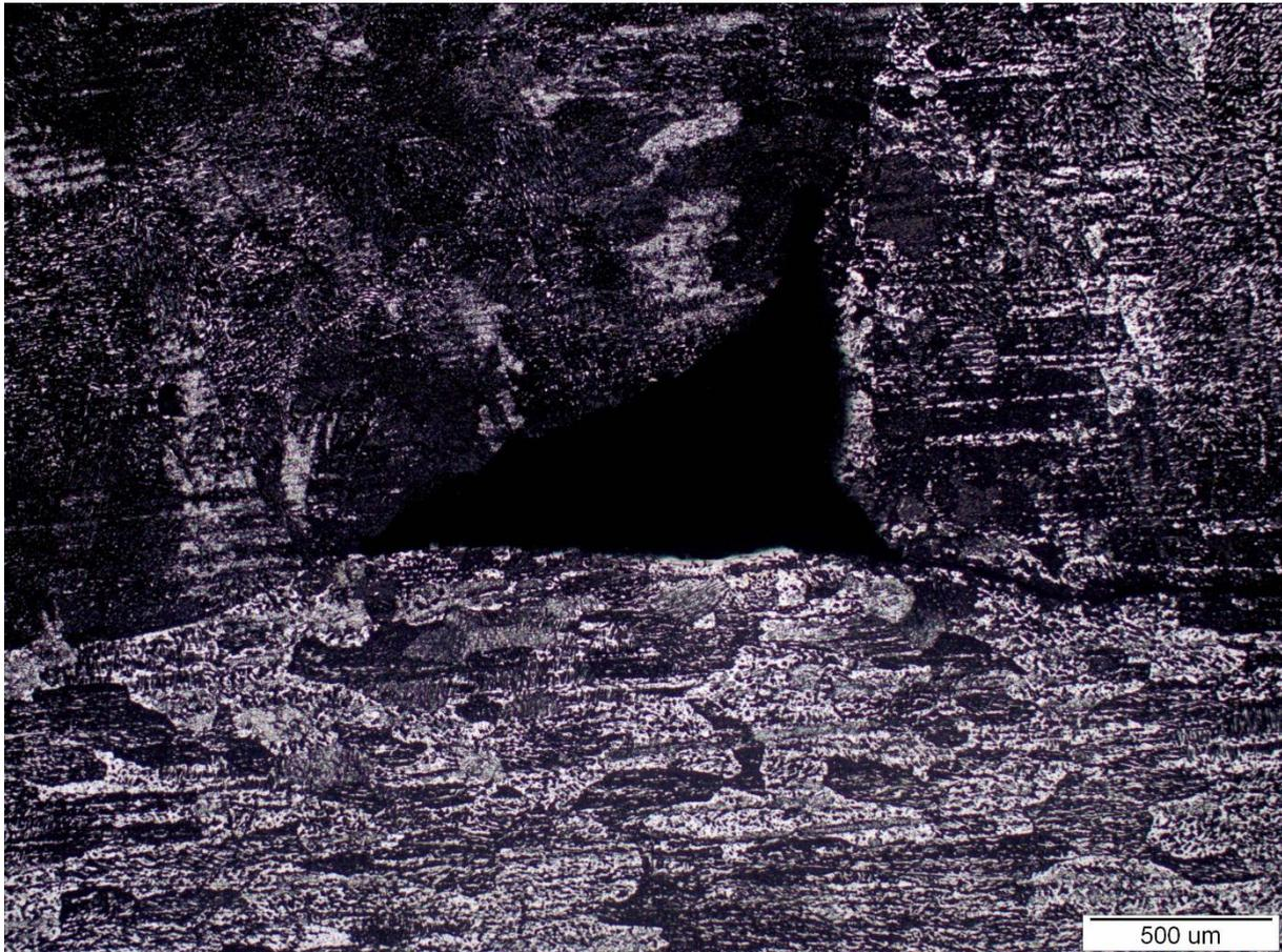
Slika 55: Greška nedovoljnog provara korijena (povećanje 50x)
