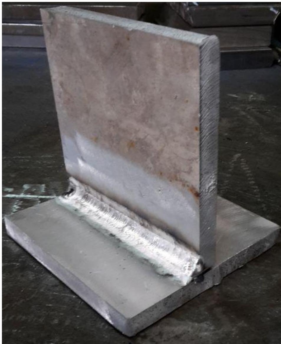
Slika 45: Ispitni uzorak za certifikaciju zavarivača
