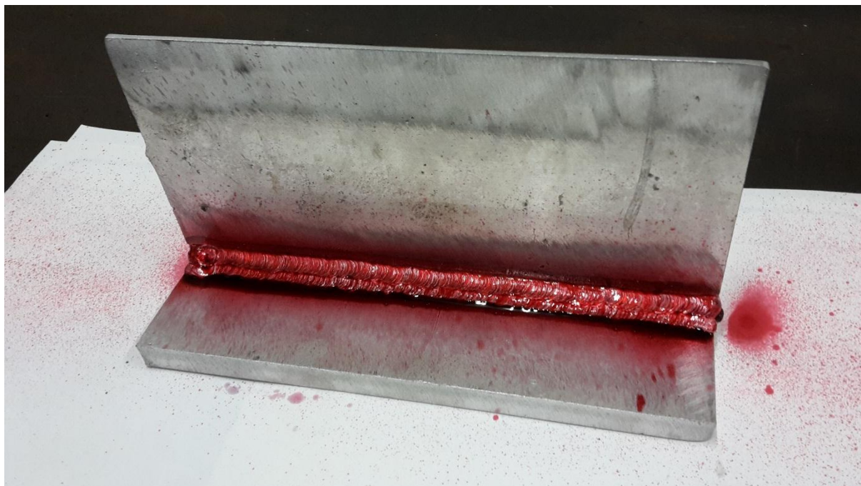
Slika 49: Sloj penetranta na ispitnom uzorku
