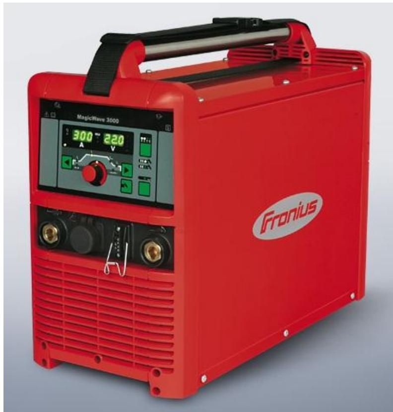
Slika 30: Izvor struje za TIG postupak zavarivanja [22]
