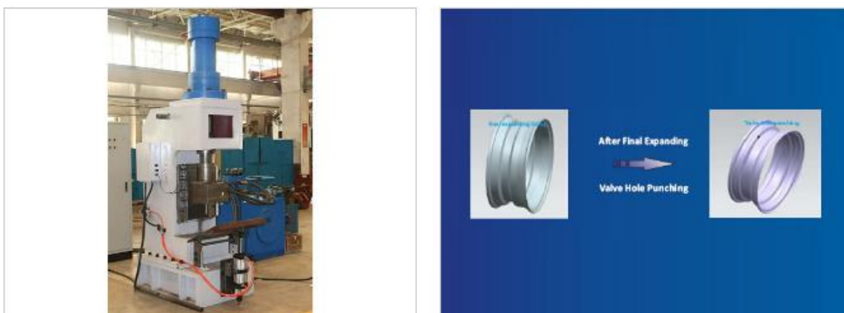
Slika 4.8 Testiranje nepropusnosti plina, probijanje rupe za ventil [17]
