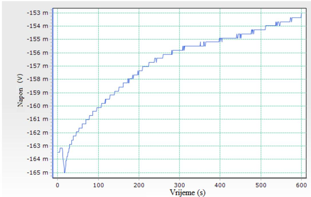
Slika 47. Dijagram otvorenog strujnog kruga za uzorak AISI 316
