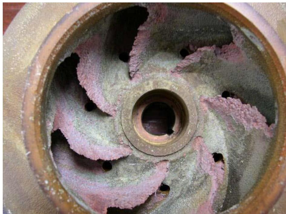
Slika 9. Erozijska korozija na lopaticama [13]
