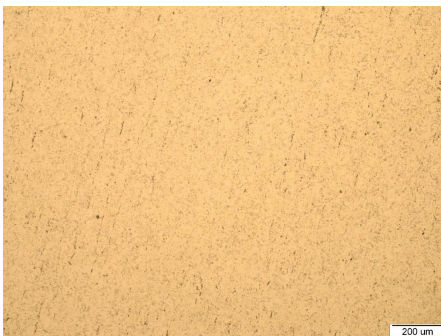
Slika 33. Prikaz mikrostrukture AISI 316 pri povećanju 100x
