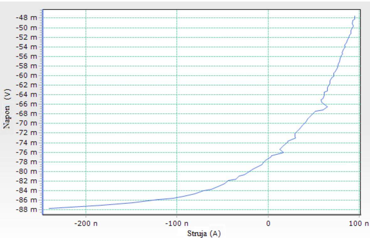
Slika 45. Dijagram polarizacijskog otpora za uzorak UNS S32205
