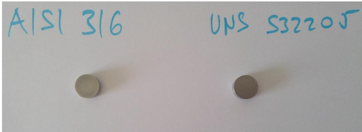
**Slika 57. Površina uzorka nakon provedenih elektrokemijskih ispitivanja**
