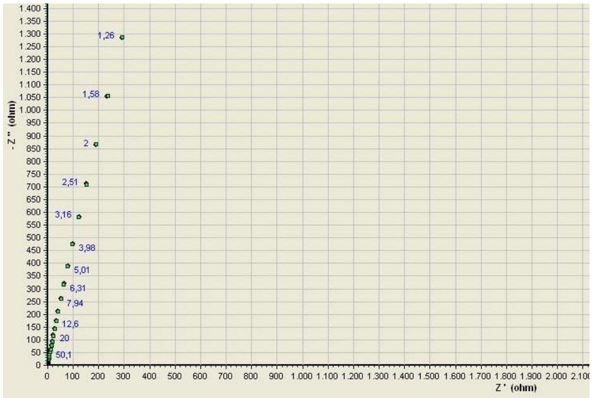
**Slika 52.** Preklopljeni Nyquistovi dijagrami za uzorak AISI 316
