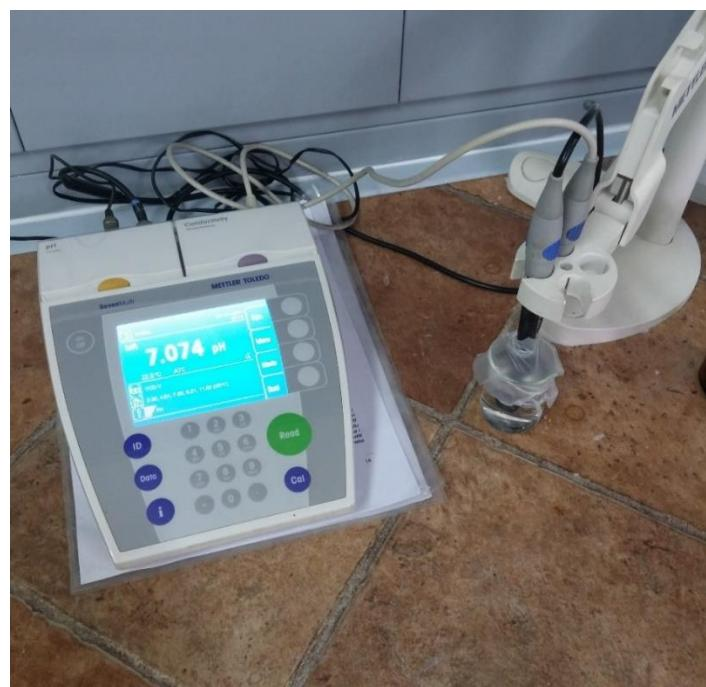
Slika 42. Uredaj za mjerene pH i elektrovodljivosti otopine
