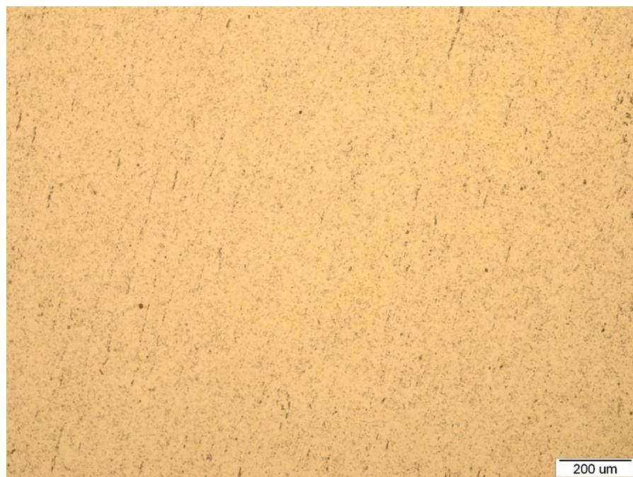
Slika 33. Prikaz mikrostrukture AISI 316 pri povećanju 100x
