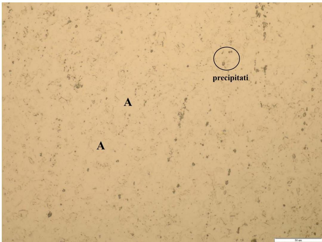
Slika 34. Prikaz mikrostrukture AISI 316 pri povećanju 500x
