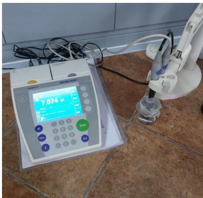
Slika 42. Uređaj za mjerenje pH i elektrovljivosti otopine
