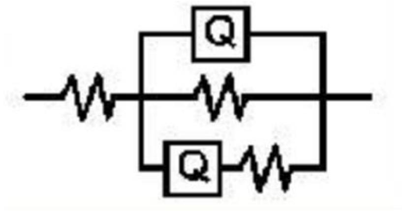
Slika 51. Ekvivalentni električni krug za uzorak AISI 316
