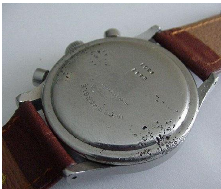
Slika 8. Rupičasta korozija na kućištu sata [14]
