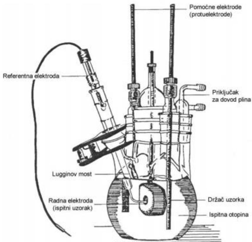
Slika 10. Prikaz čelije za elektrokemijska ispitivanja [5]
