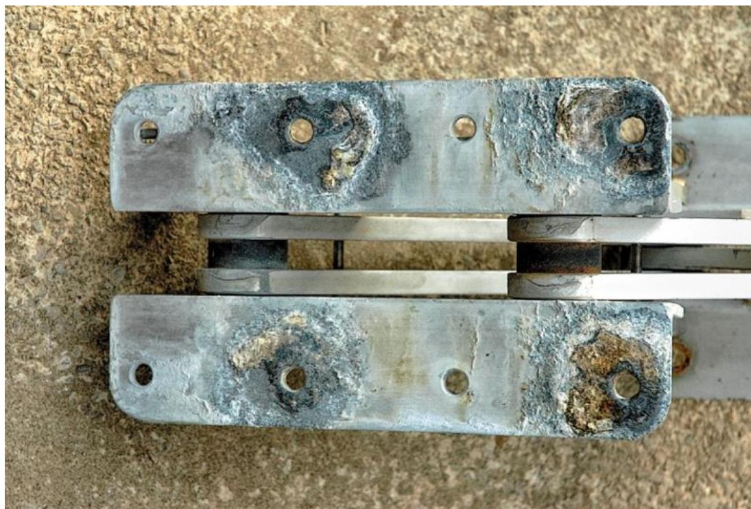
Slika 6. Prikaz galvanske korozije [11]
