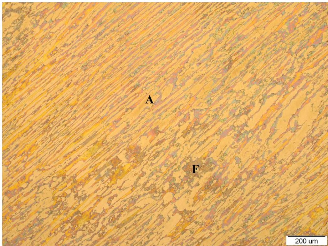
Slika 35. Prikaz mikrostrukture UNS S32205 pri povećanju 100x
