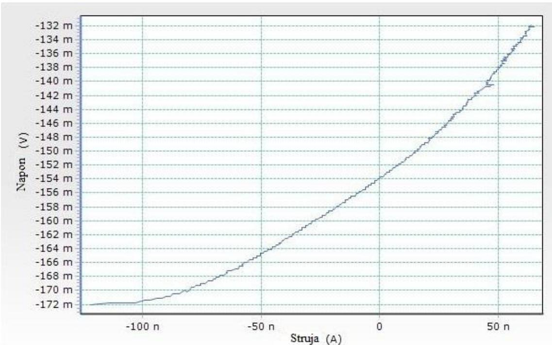
Slika 43. Dijagram polarizacijskog otpora za uzorak AISI 316
