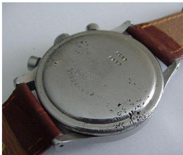
Slika 8. Rupičasta korozija na kućištu sata [14]
