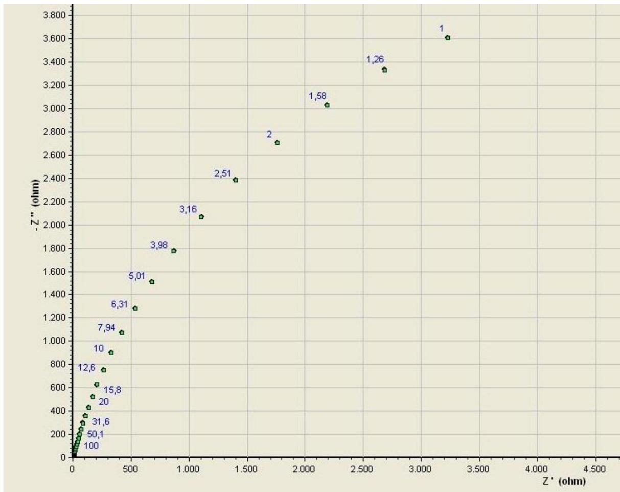
**Slika 56. Preklopljeni Nyquistovi dijagrami za uzorak UNS S32205**
