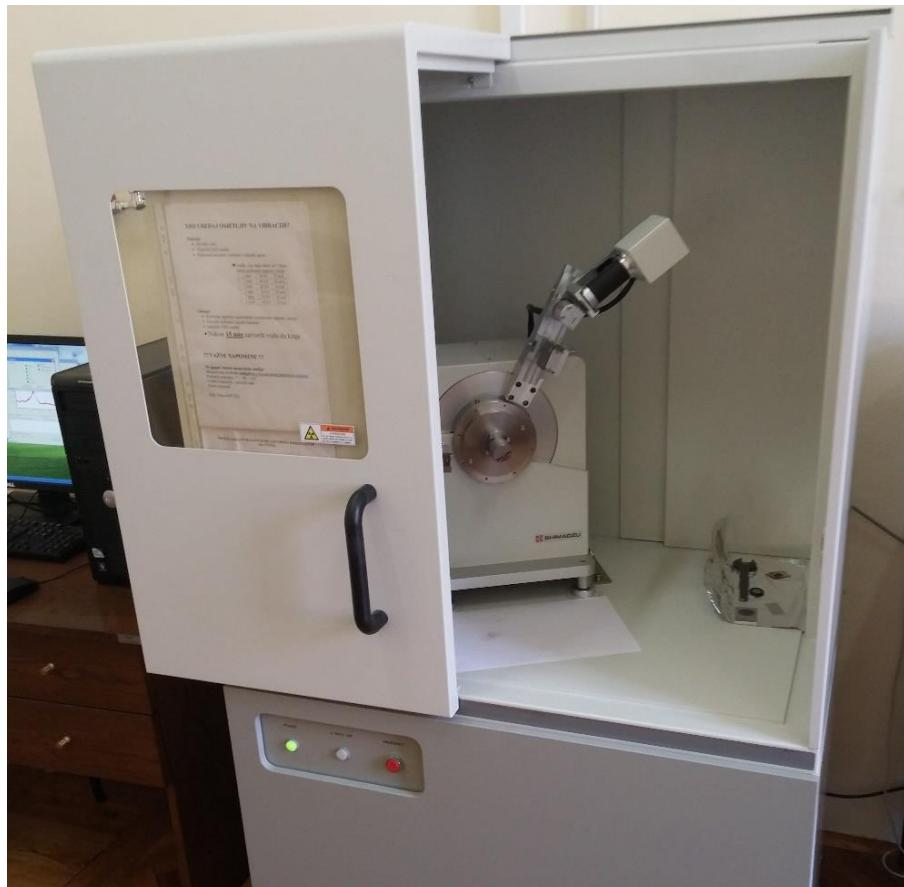
Slika 39. Uređaj za rendgensku difrakcijsku analizu Shimadzu XRD-6000
