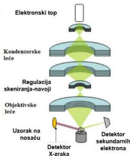
Slika 23. Princip rada SEM-a [22]
