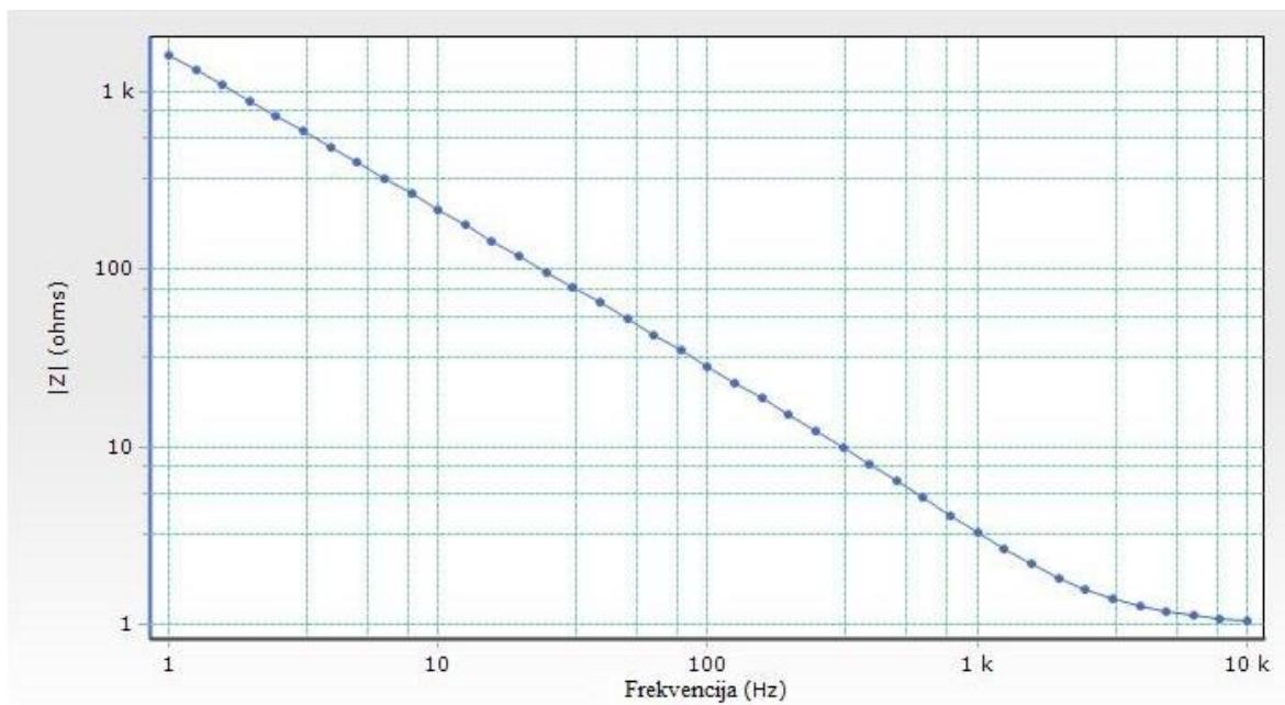
**Slika 49. Bodeov dijagram za uzorak AISI 316**
