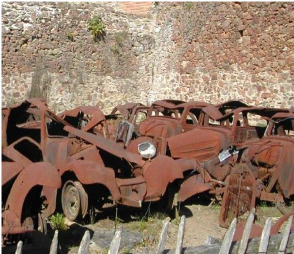
Slika 5. Primjer opće korozije [3]
