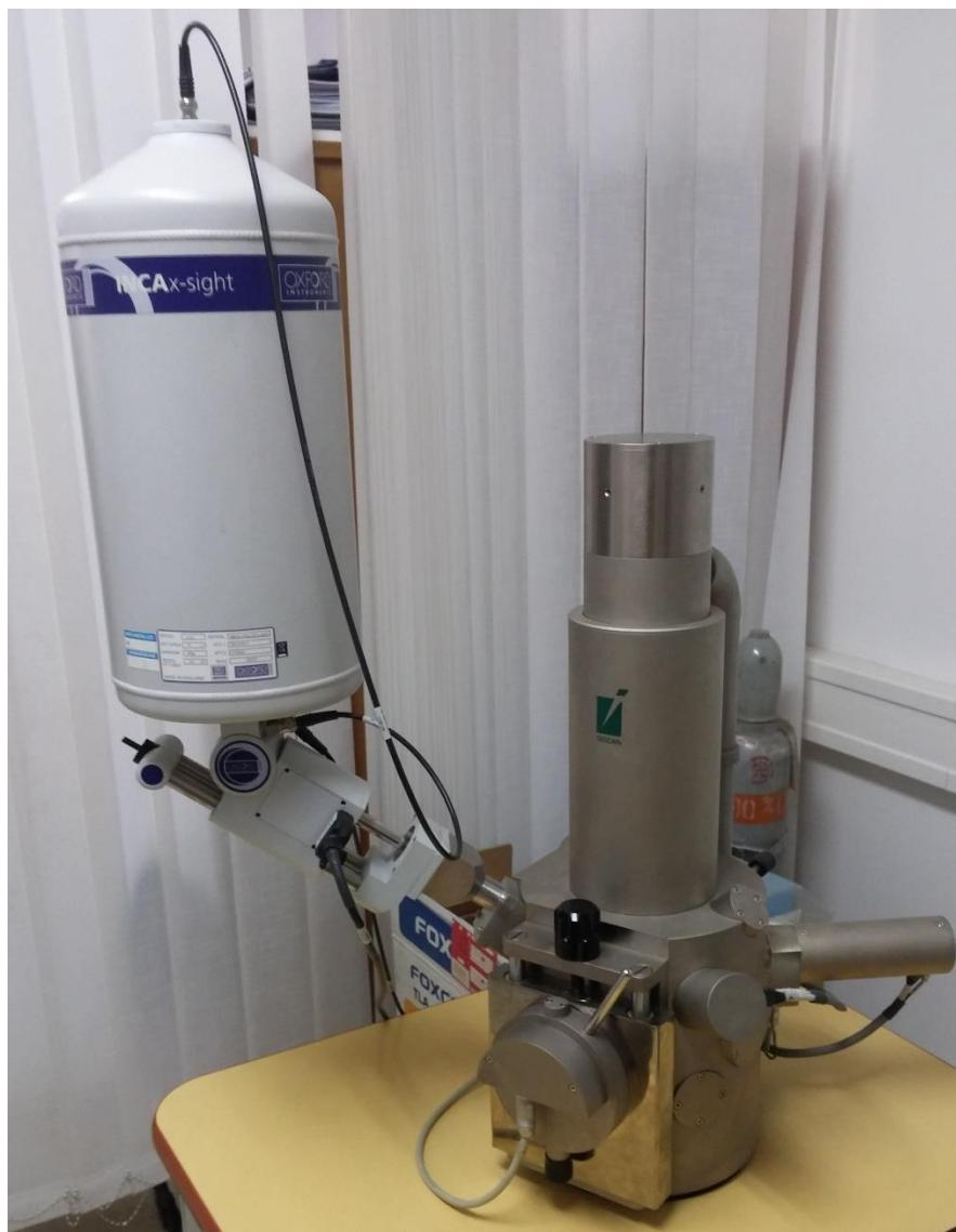
Slika 38. Tescan Vega TS5136 - Skenirajući elektronски микроскоп (SEM)
