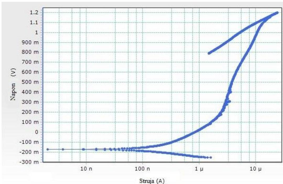
Slika 44. Dijagram cikličke polarizacije za uzorak AISI 316
