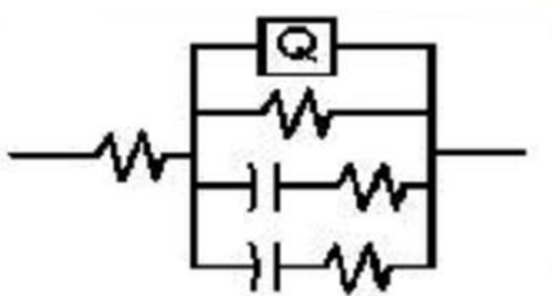
Slika 55. Ekvivalentni električni krug za uzorak UNS S32205
