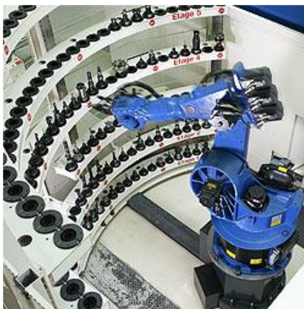
Slika 9 Slaganje alata na obradnom centru pomoću robota
