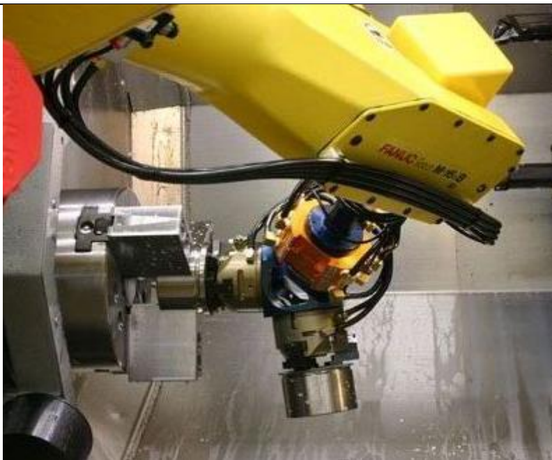
Slika 8 Skidanje izradka s CNC stroja [10]
