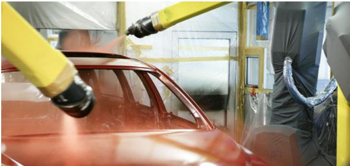
Slika 10 Upotreba robota u lakiranju karoserije automobila [11]
