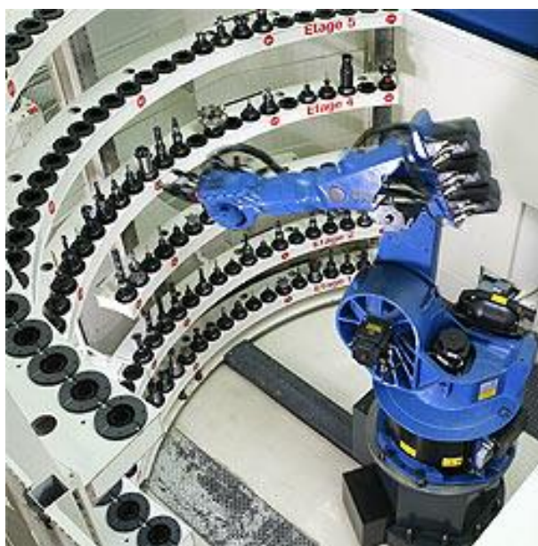
Slika 9 Slaganje alata na obradnom centru pomoću robota
