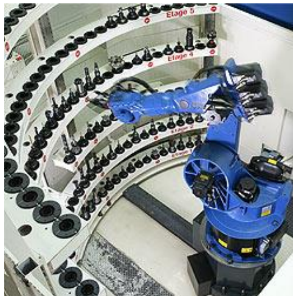
Slika 9 Slaganje alata na obradnom centru pomoću robota
