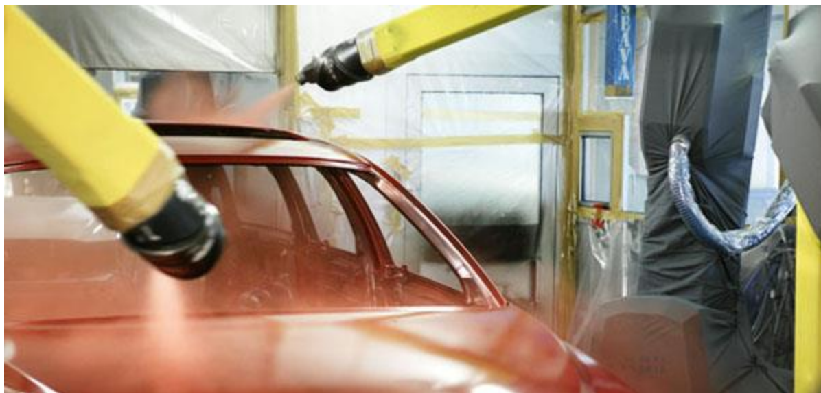
Slika 10 Upotreba robota u lakiranju karoserije automobila [11]
