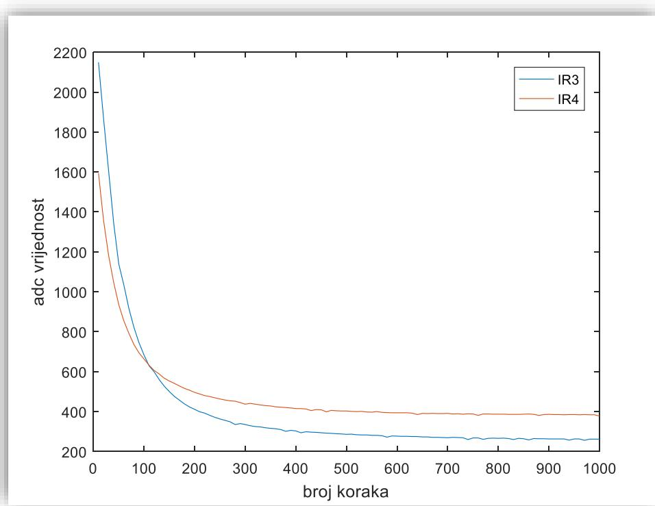
Slika 34. Očitanje senzora IR3 i IR4 kada se robot udaljava od zida
