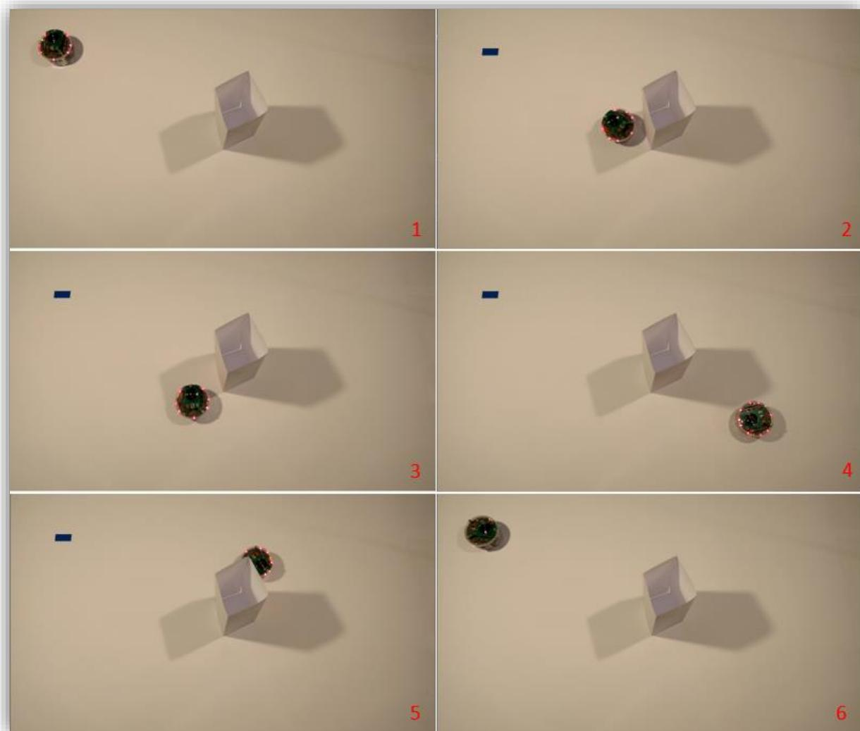
Slika 62. Zaobilaženje prepreke: 1) robot u početnoj poziciji; 2) robot kada uoči prepreku; 3) robot kada se dovoljno udalji od prepreke; 4) robot u krajnjoj poziciji; 5) robot u povratku zaobilazi prepreku; 6) robot kako se vratio na početak.
