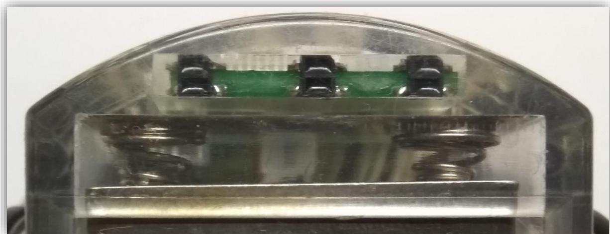
**Slika 49. E-puck robot s ugrađenim senzorom**
