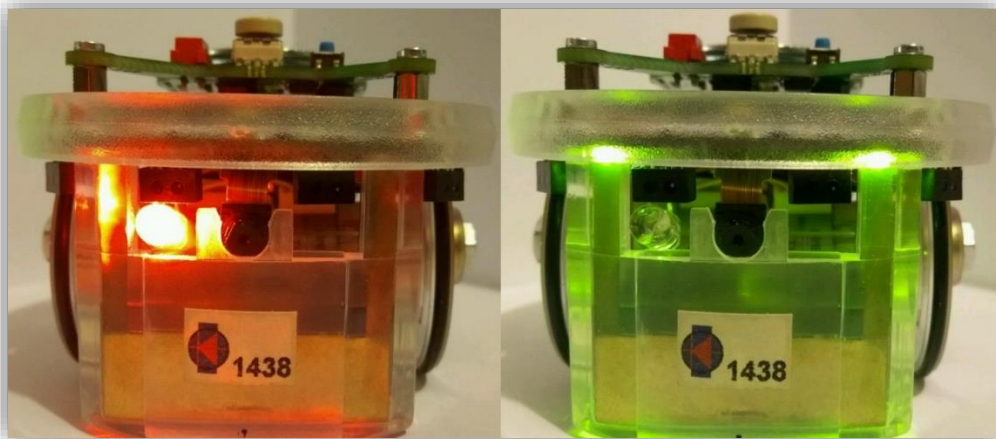
Slika 47. Lijevo robot s upaljenom prednjom LED diodom i desno s upaljenom body LED diodom
