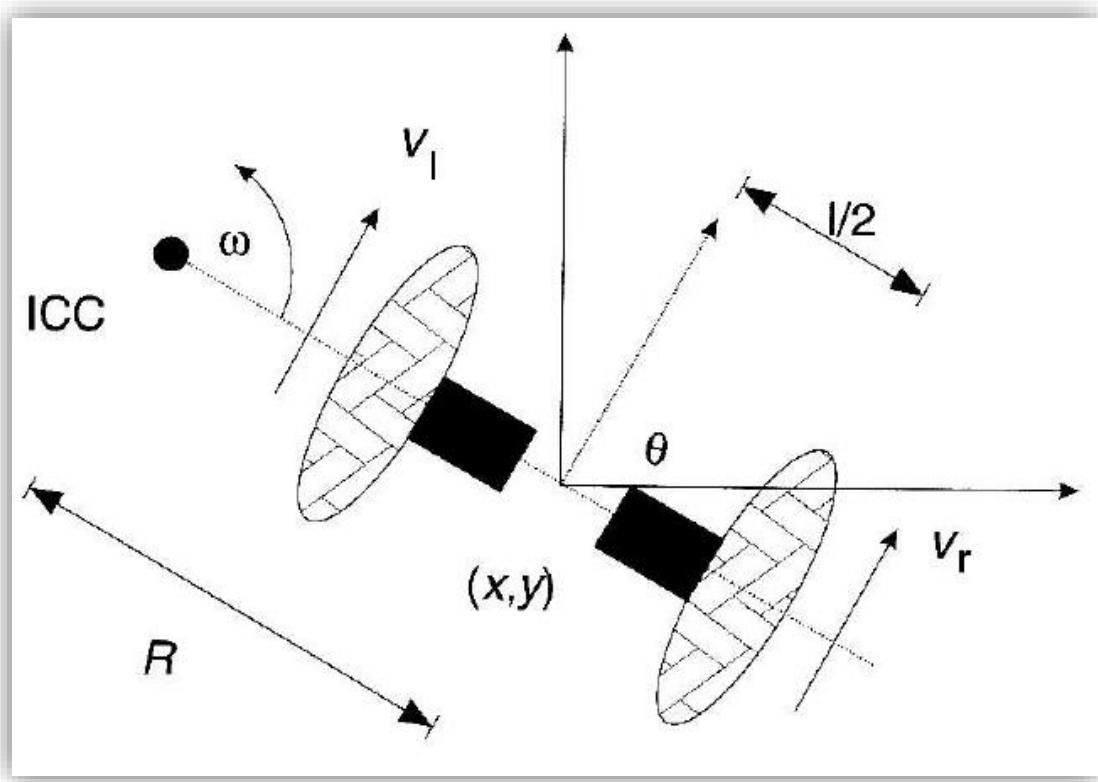
**Slika 63. Kinematika mobilnog robota s diferencijalnim pogonom [13]**
