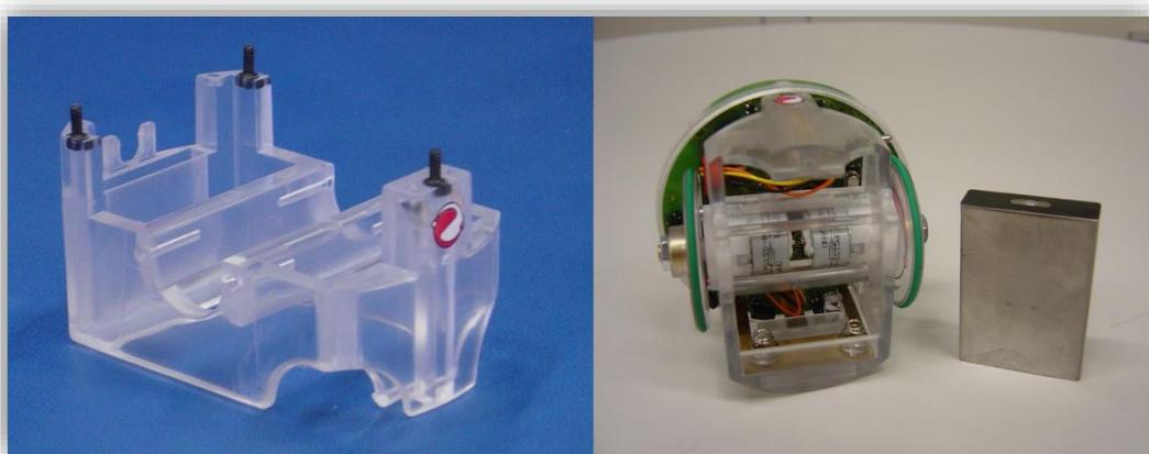
Slika 26. Kućište sa i bez komponenti [3]
