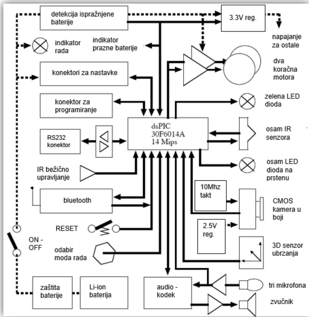
Slika 29. Električna struktura *e-puck* robota [4]
