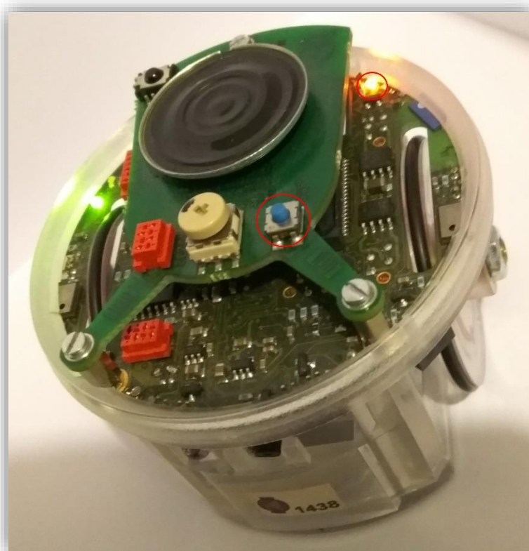
Slika 24. Narančasti LED indikator i reset tipka
