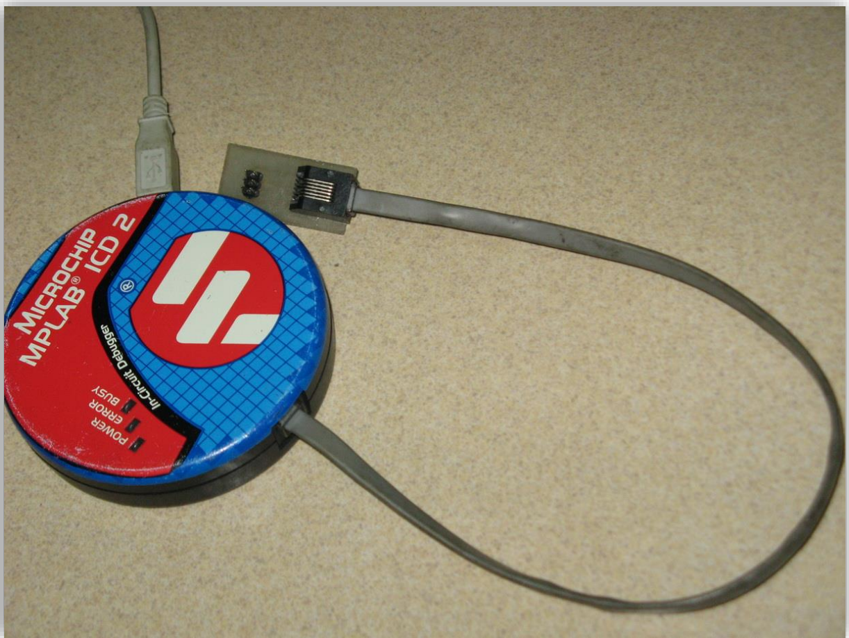
Slika 2. MPLAB ICD 2 programator [8]
