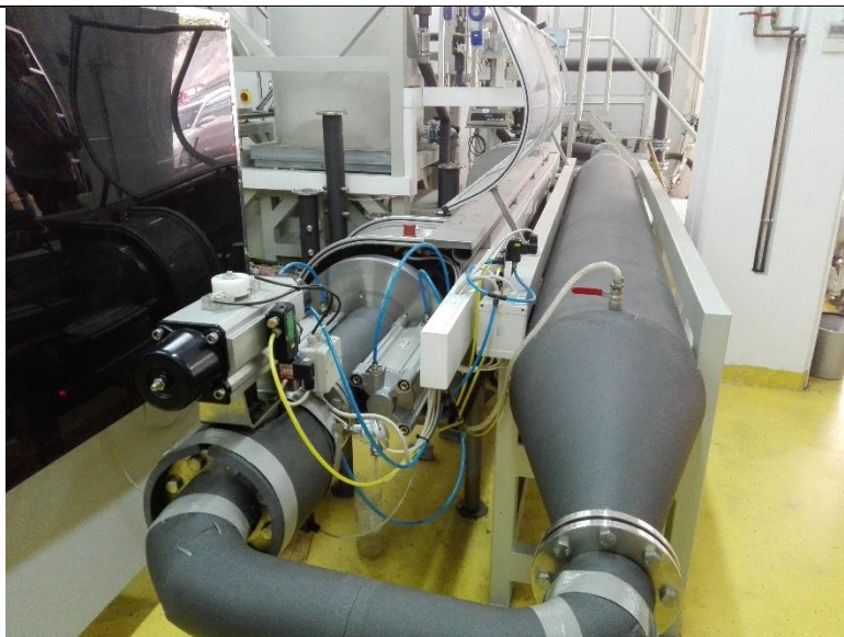
Slika 24. Ispitna klupa sa smirivačem protoka
