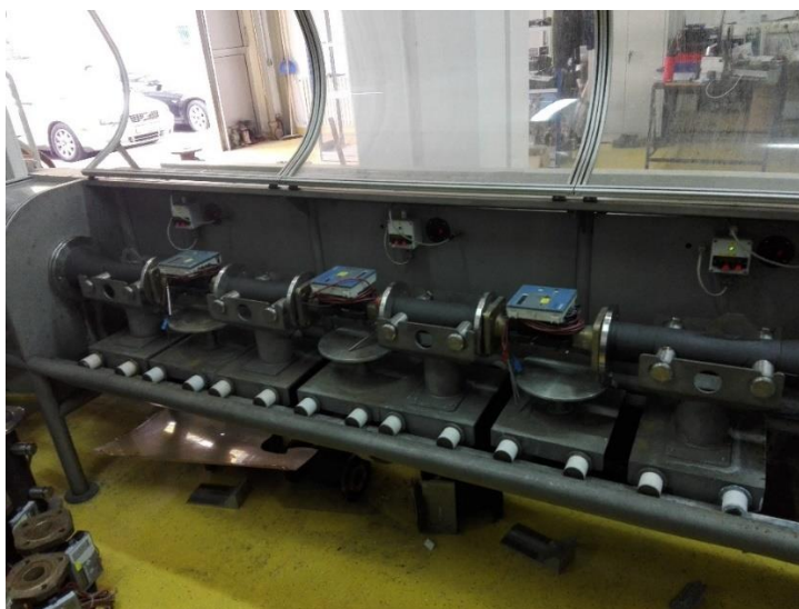
Slika 19. Ispitna klupa sa priključenim mjerilima toplinske energije
