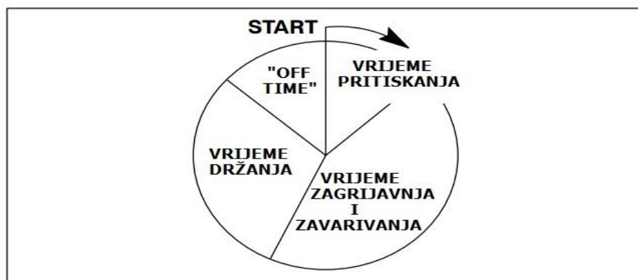
Slika 16. Vremenski ciklusi pri elektrootpornom zavarivanju [12]
