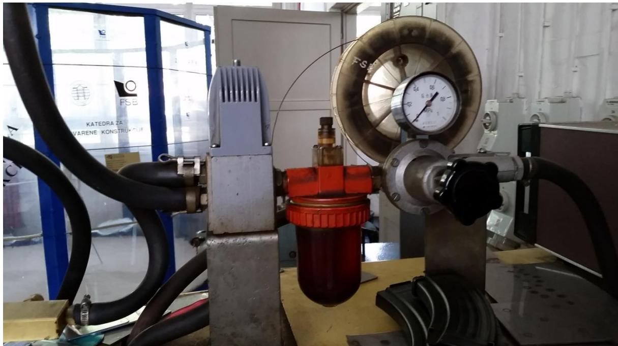
**Slika 28.** Manometar, nauljivač i elektromagnetski razvodnik
