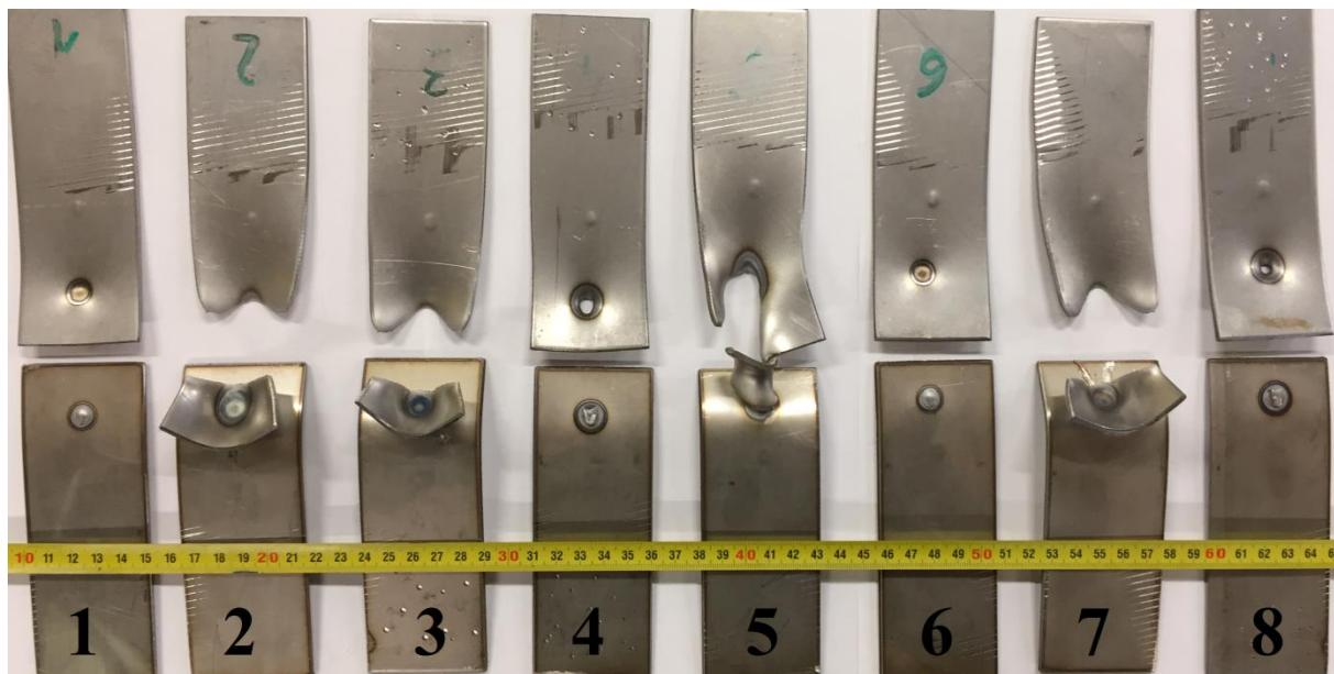
**Slika 47.** Uzorci nakon ispitivanja na kidalici
