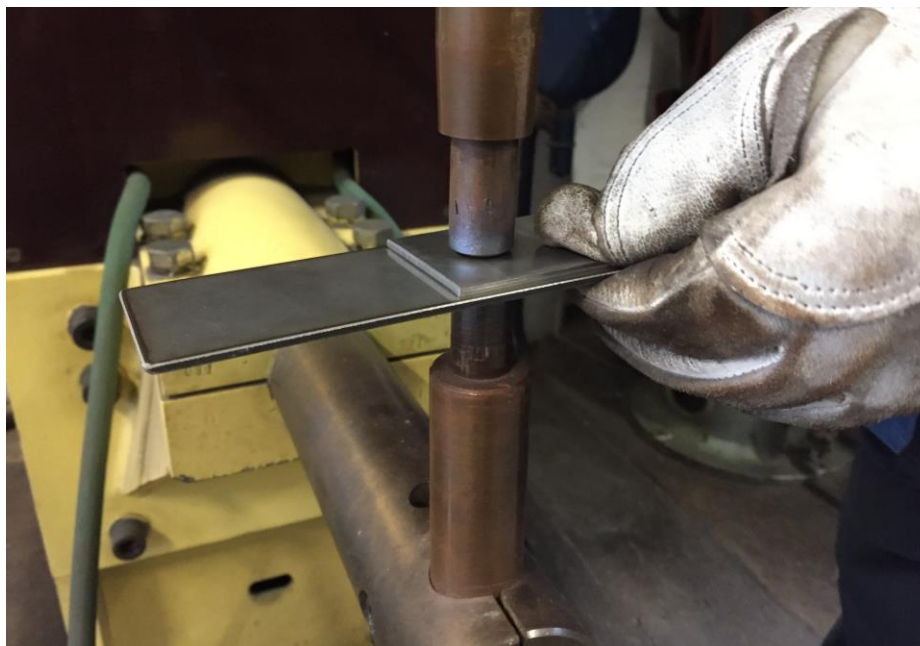
Slika 38. Pozicioniranje uzorka prije zavarivanja na stroju DZ-63
