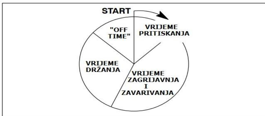
**Slika 16.** Vremenski ciklusi pri elektrootpornom zavarivanju [12]
