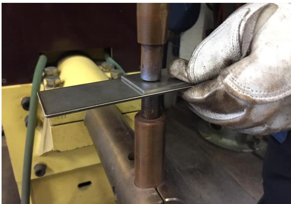
**Slika 38.** Pozicioniranje uzorka prije zavarivanja na stroju DZ-63
