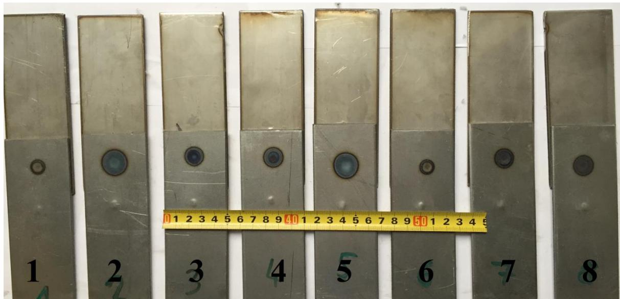
**Slika 39.** Lice zavarene točke (kontakt: radni komad – gornja elektroda)
