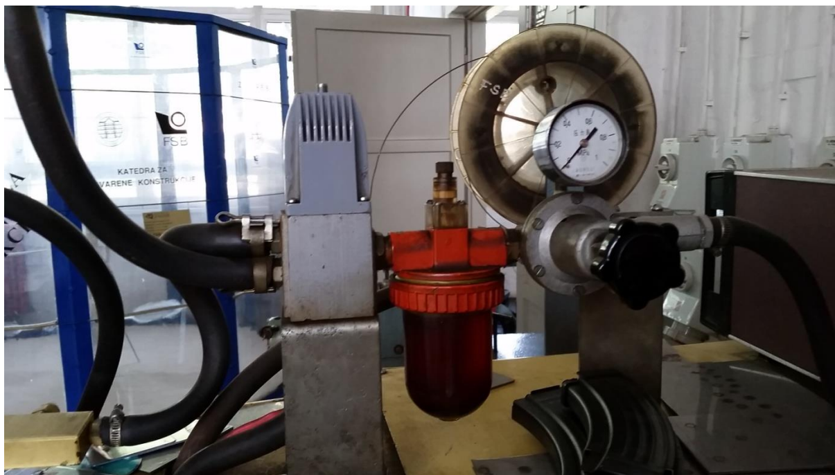
Slika 28. Manometar, nauljivač i elektromagnetski razvodnik
