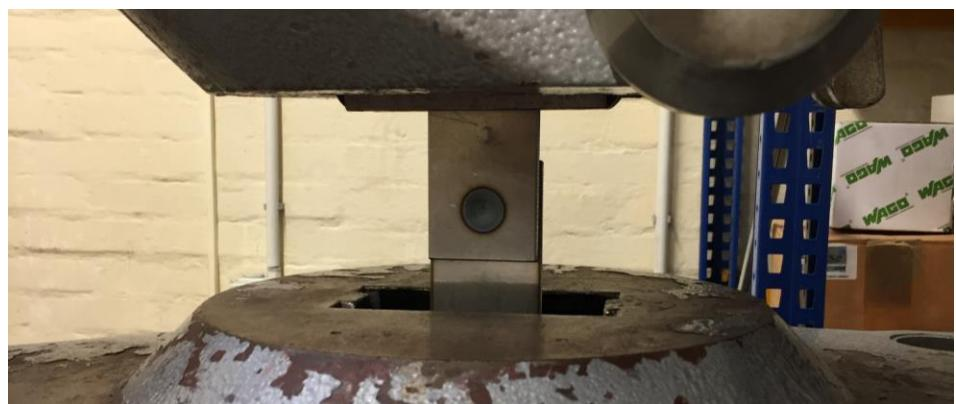
**Slika 45.** Uzorak stegnut u čeljusti kidalice
