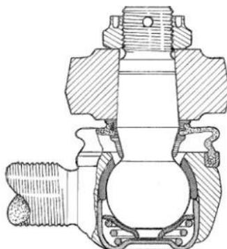
Slika 26. Kuglasti zglobov
