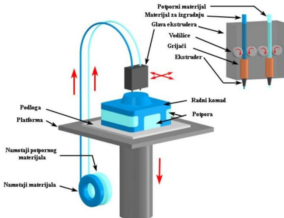
Slika 5. Princip FDM procesa
