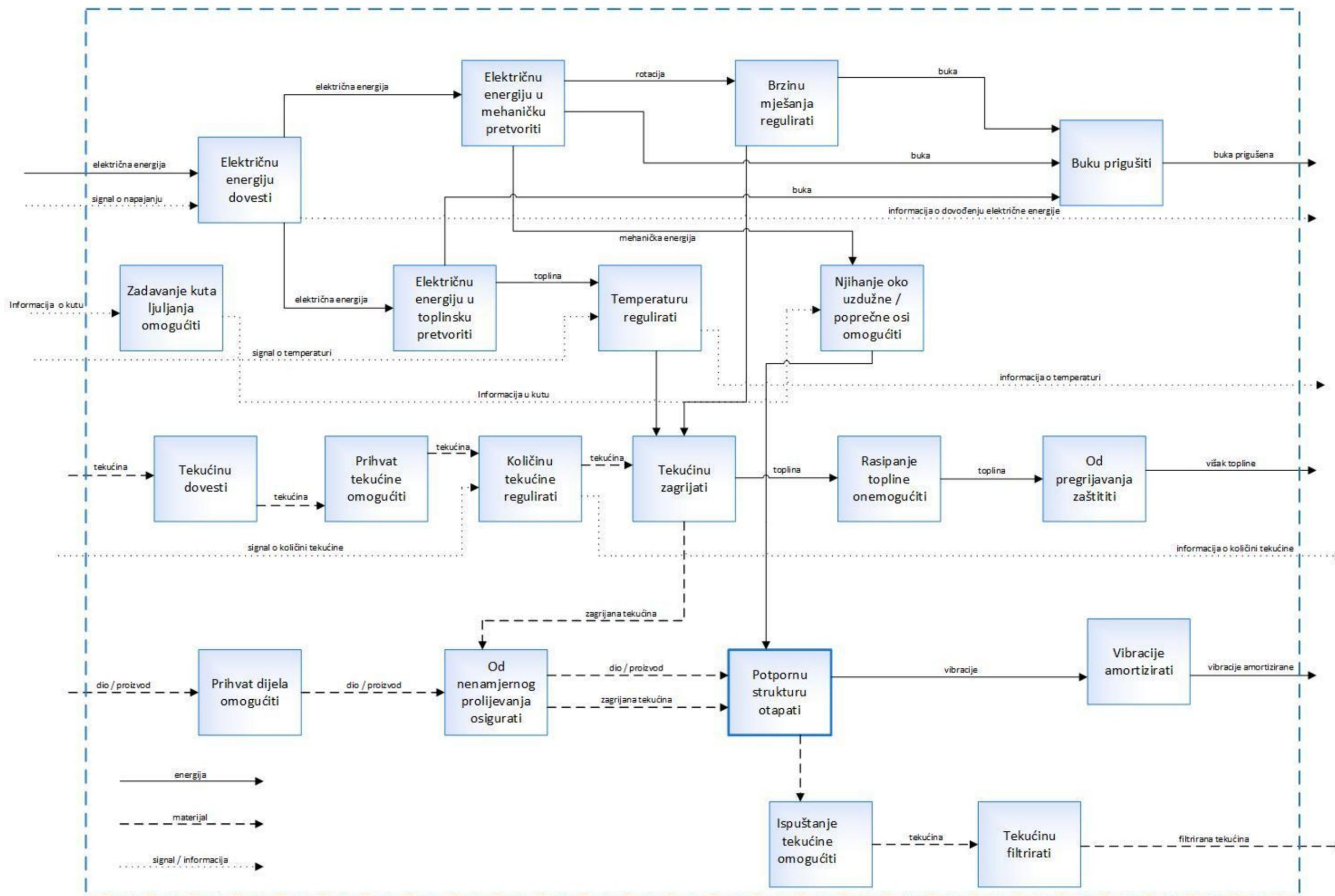
Slika 15. Funkcijska dekompozicija uređaja
