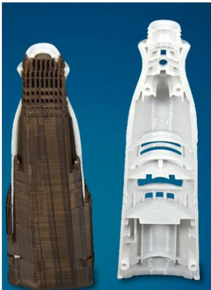
Slika 6. Otapanje potpornih struktura
