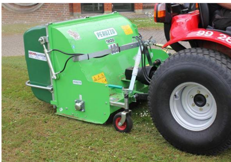
Slika 14. Koala priključena na traktor [3]
