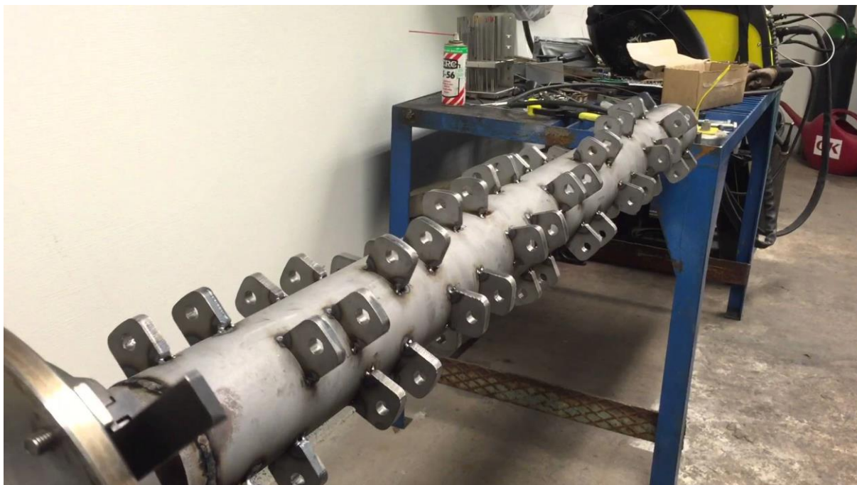
Slika 36. Prikaz zavarivanja nosača noževa na cijev[12]
