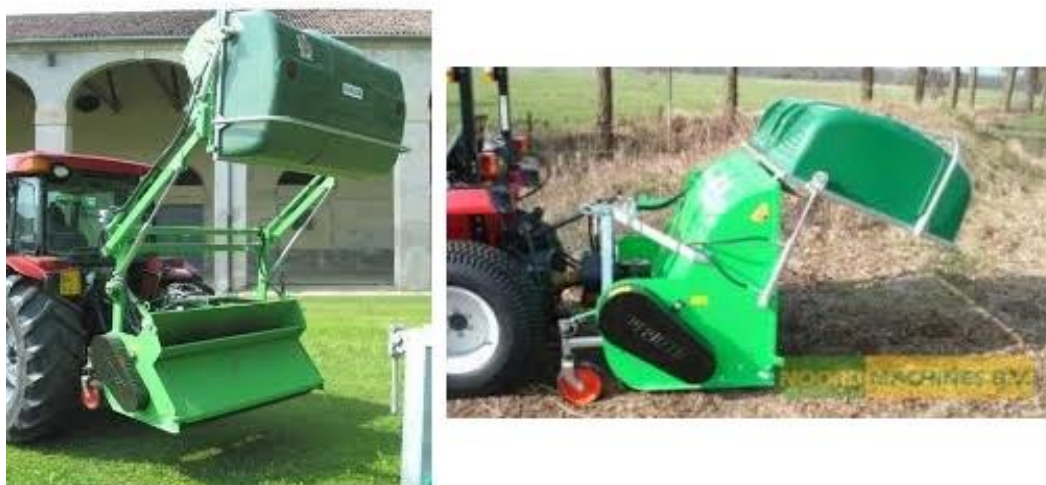
Slika 15. Istovar pokošene trave (hidraulika) [3]
