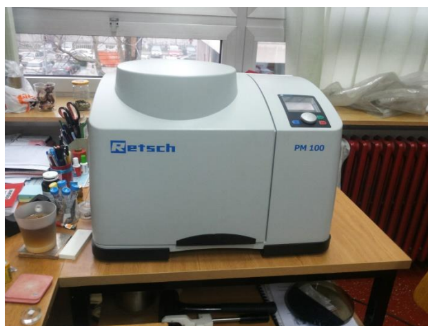
Slika 12 Planetarni kuglični mlin Retsch PM100
