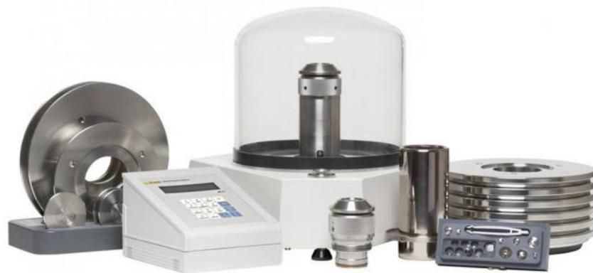
**Slika 16. Plinska tlačna vaga PG7601**
