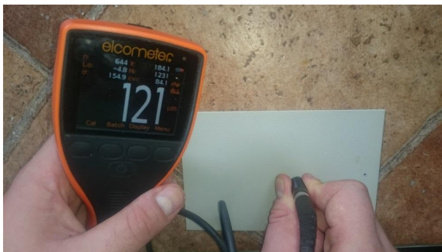
Slika 23. Postupak mjerenja debljine prevlake uređajem Elcometer 456
