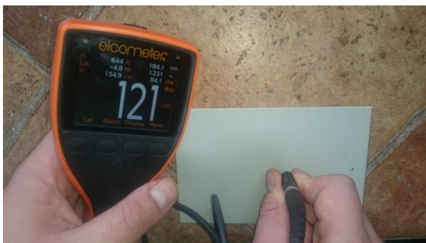
Slika 23. Postupak mjerenja debljine prevlake uređajem Elcometer 456
