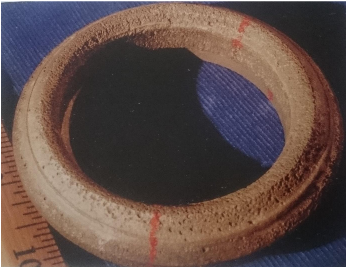
Slika 3. Rupičasta korozija aluminija [5]
