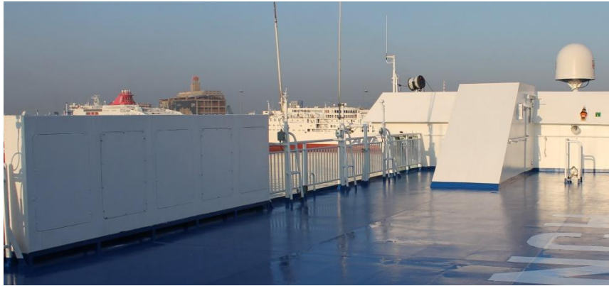
Slika 17. Paluba zaštićena poliuretanom [19]
