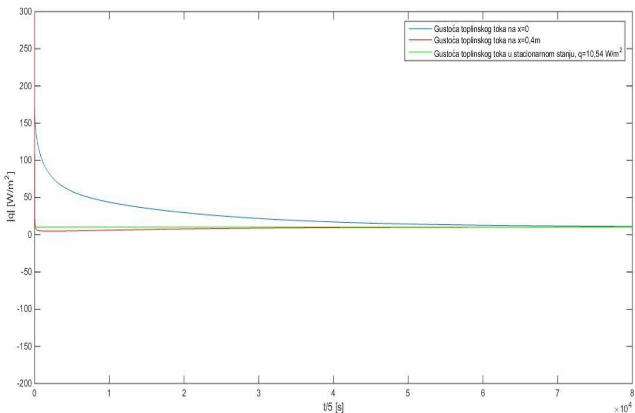
**Slika 14** Trenutne vrijednosti gustoće toplinskih tokova na rubnim površinama za slučaj kad je izolacija s vanjske strane zida
