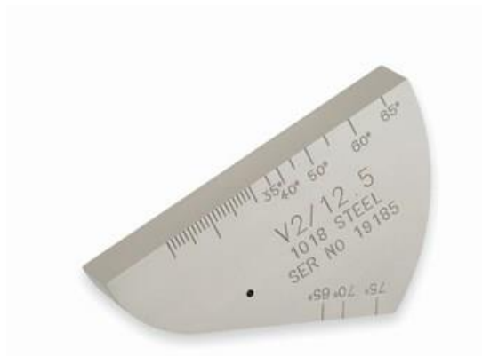
Slika 8. Radni etalon br.2 [11]
