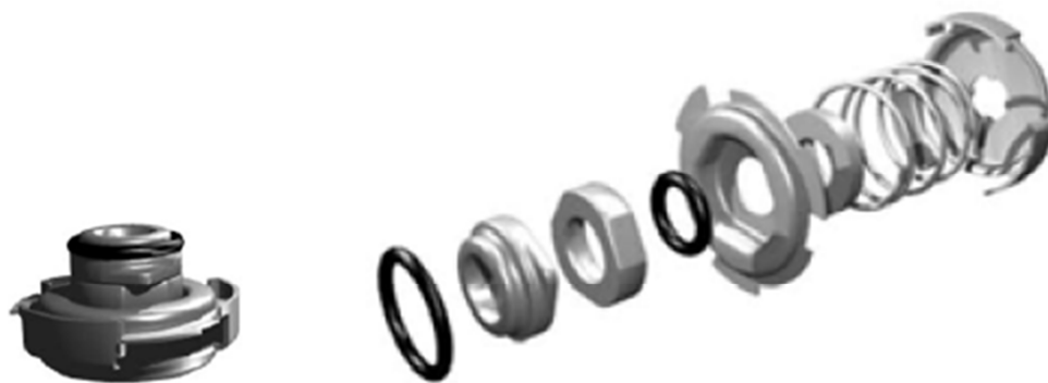
Slika 4.4 Brtva vratila i pripadajući shematski prikaz
