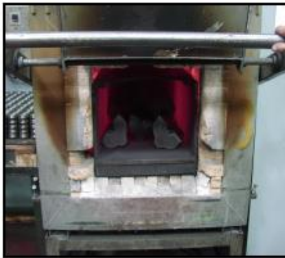
Slika 4. Zagrijevanje kalupa u peći [6]
