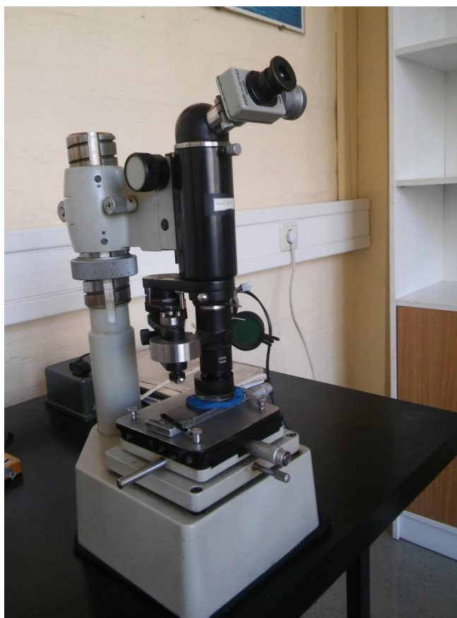
Slika 5.17 Uređaj za ispitivanje mikrotvrdoće
