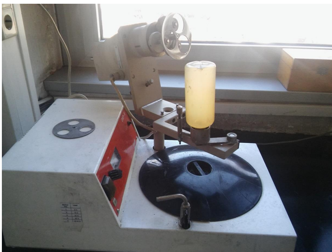
Slika 5.15 Uređaj za poliranje uzorka
