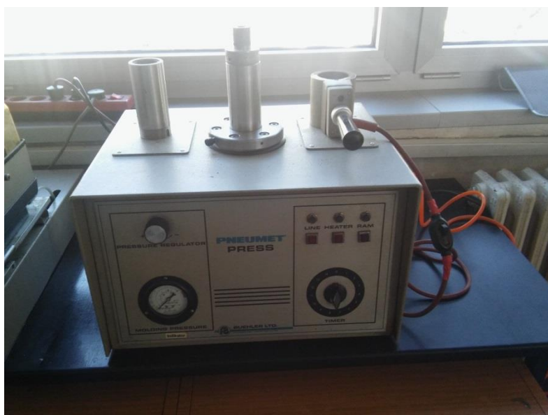
Slika 5.16 Uređaj za izradu kalupa
