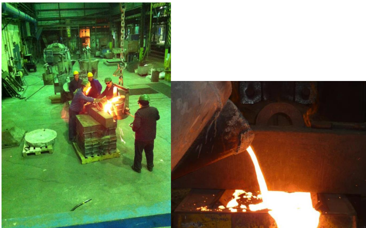
Slika 5.8 Prenosenje taljevine u loncu i ulijevanje u pješčani kalup
