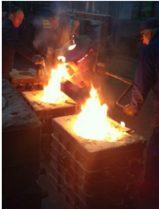
Slika 5.5 Cijepljenje u mlaz
