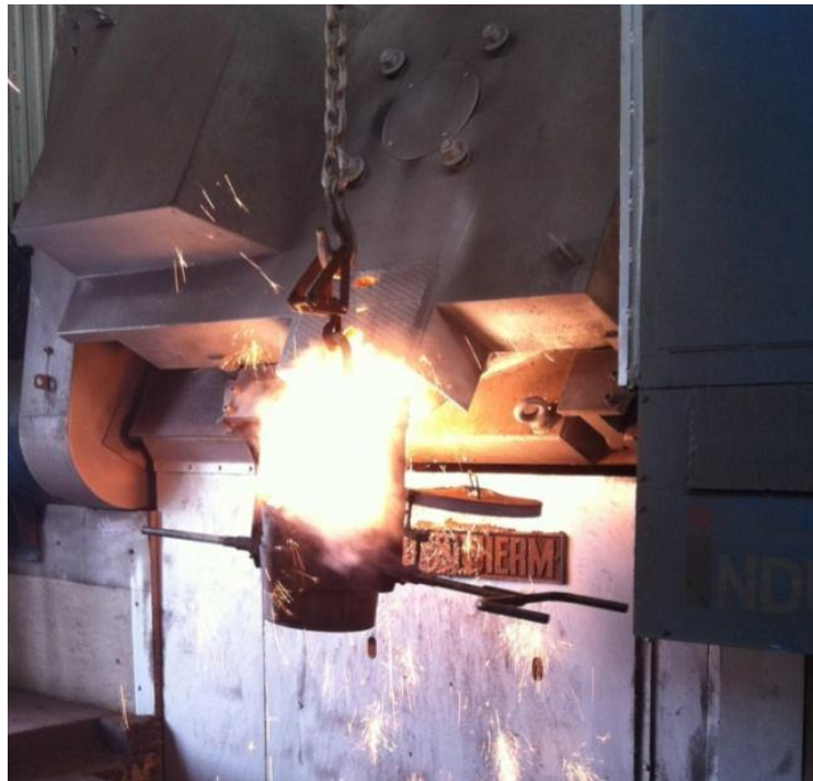
Slika 5.3 Ispust bazne taljevine iz peći u Sandwich lonac
